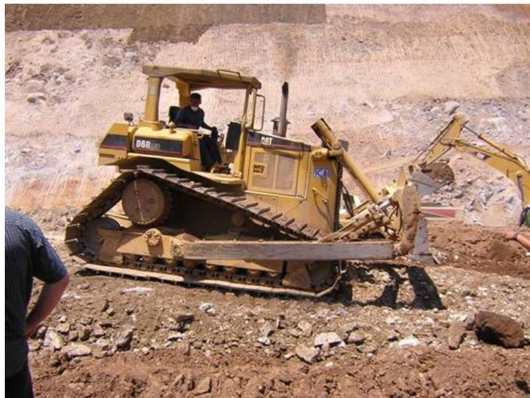
Fotografía 23: Equipo utilizado (Tractor D6R)
