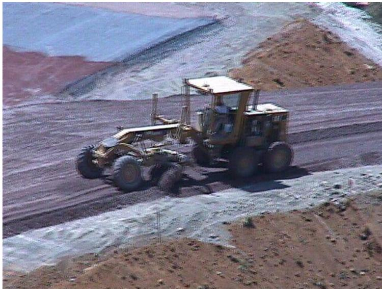
*Fotografía 17: Equipo utilizado (Motoconformadora)*
