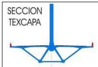
*Imagen 2: Sección hueca del Puente Texcapa*
