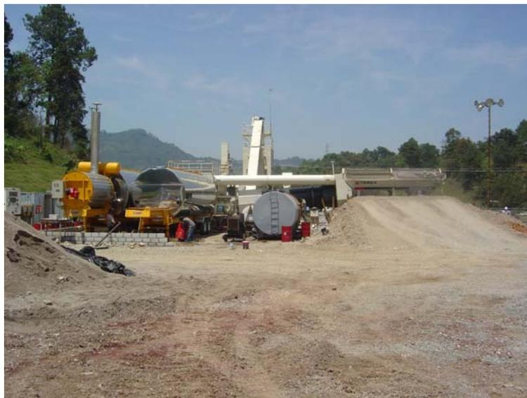
*Fotografía 53: Planta portátil para concreto asfáltico*
