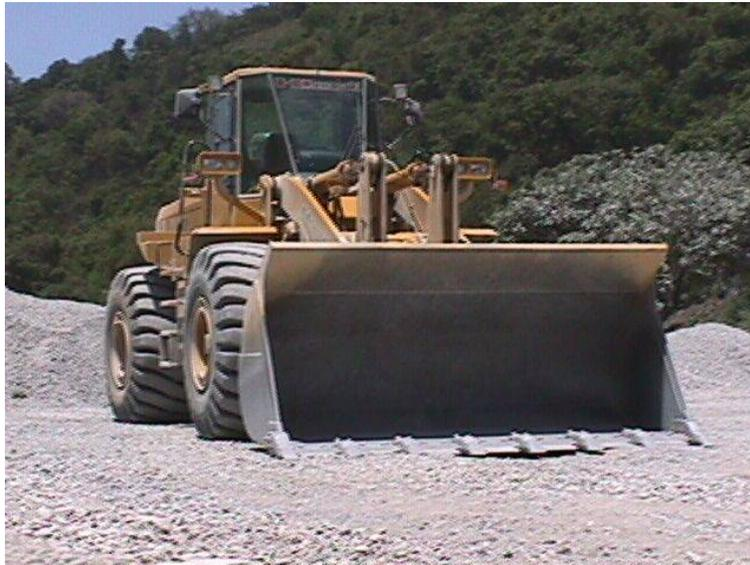
*Fotografía 16: Equipo utilizado (Cargador frontal)*
