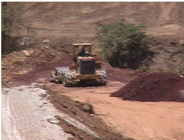
*Fotografía 19: Equipo utilizado (Rodillo pata de cabra)*
