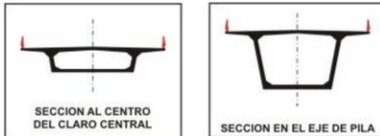
Imagen 3: Sección hueca de las dovelas del Puente Huayatlaxco.
