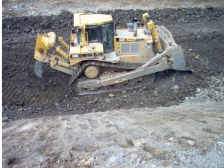
Fotografía 22: Equipo utilizado (Tractor D8R)
