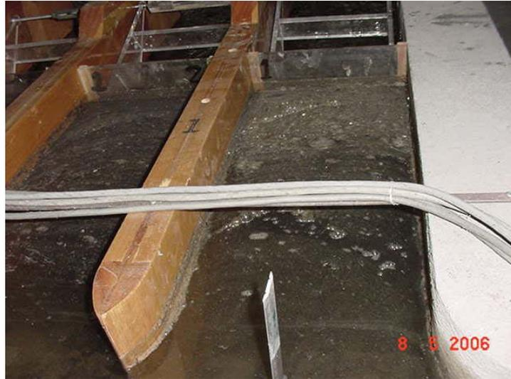
*Fig. 5.11 Efecto de las pilas aguas arriba.*
