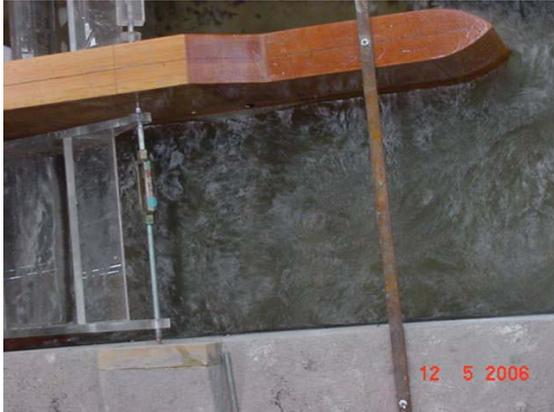
Fig. 5.17 Turbulencia detrás de la compuerta
