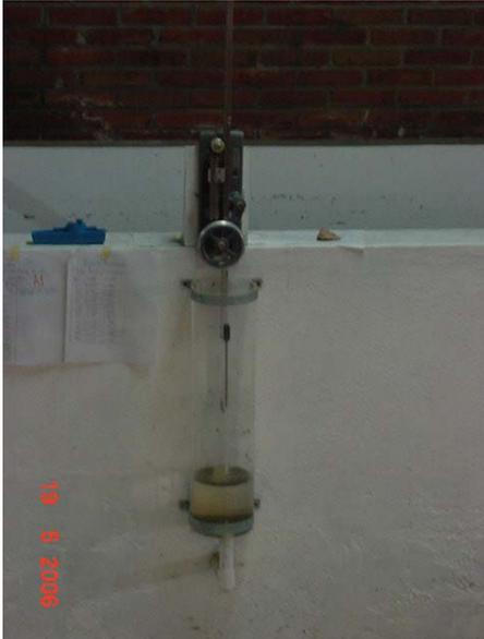
*Fig. 2.3.a. Limnímetro.*
