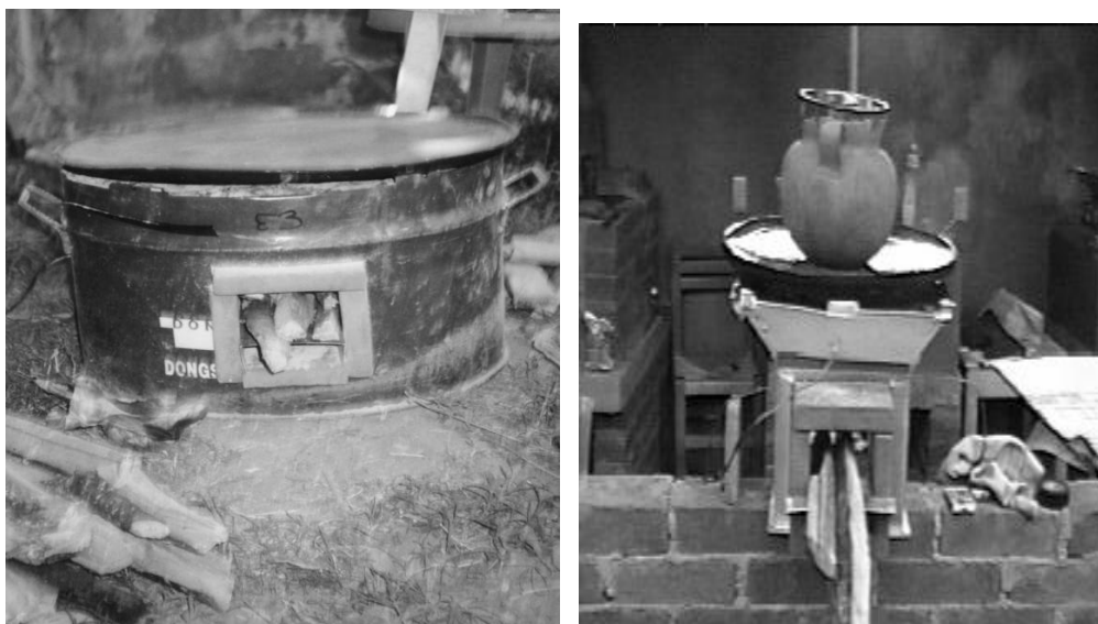
Imagen 1.2 Estufas Rocket portátiles de dos diferentes tipos y sin hornillas, ubicadas el laboratorio de estufas.
