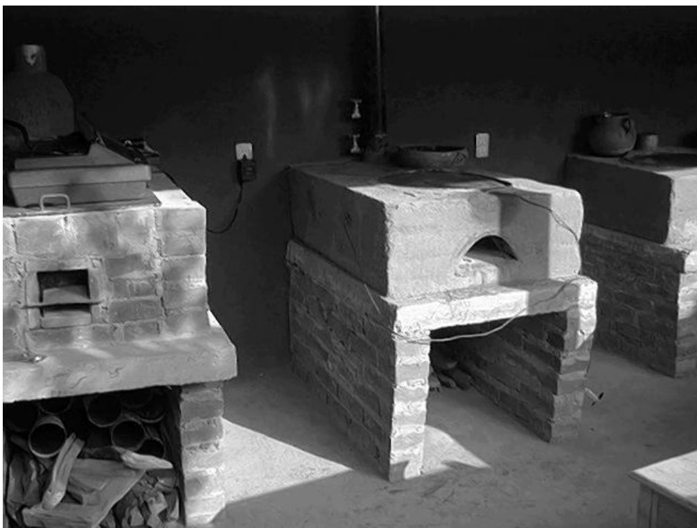
Imagen 1.1 Estufas Justa y Lorena de una y dos cámaras de combustión, dos hornillas, ubicadas en el laboratorio de estufas.
