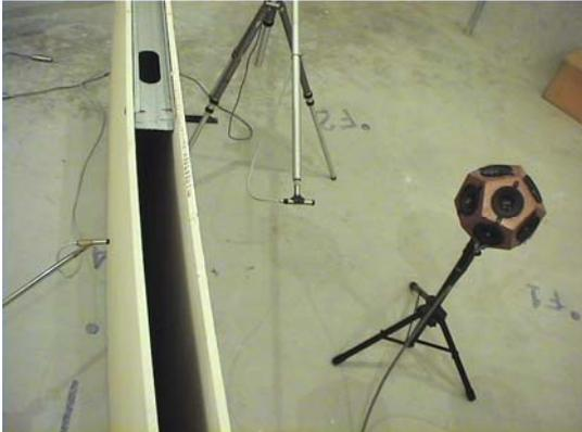
Foto 4.3. Vista superior del montaje de dispositivos para la medición in situ.
