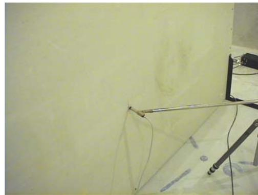
Foto 4.2. Montaje del micrófono para la medición del sonido transmitido por el espécimen.
