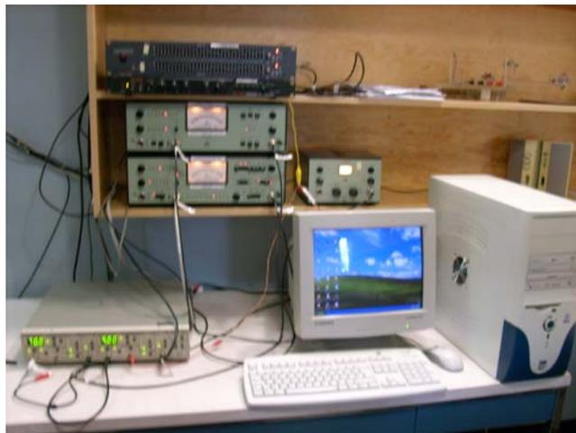
Foto 3.4 Instrumental empleado en el exterior de la cámara de transmisión para adquirir y procesar las señales de las cámaras emisora y receptora.
