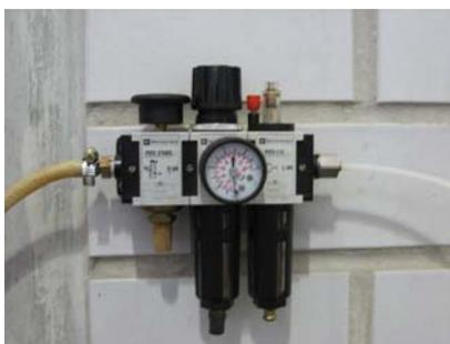
**Fig. 2.6 Regulador de presión utilizado en el arreglo final**
