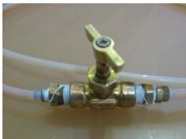
**Fig. 2.8 Válvula de aguja utilizada.**
