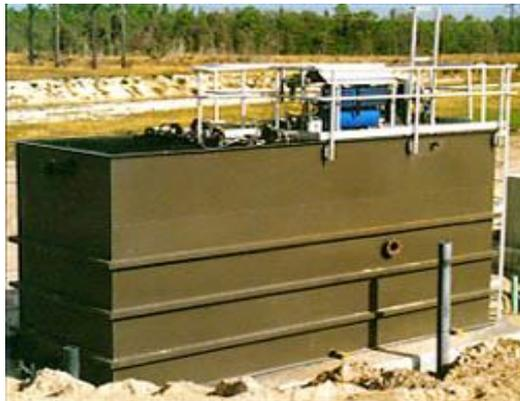
**Figura 8.** Planta paquete Filtopack
