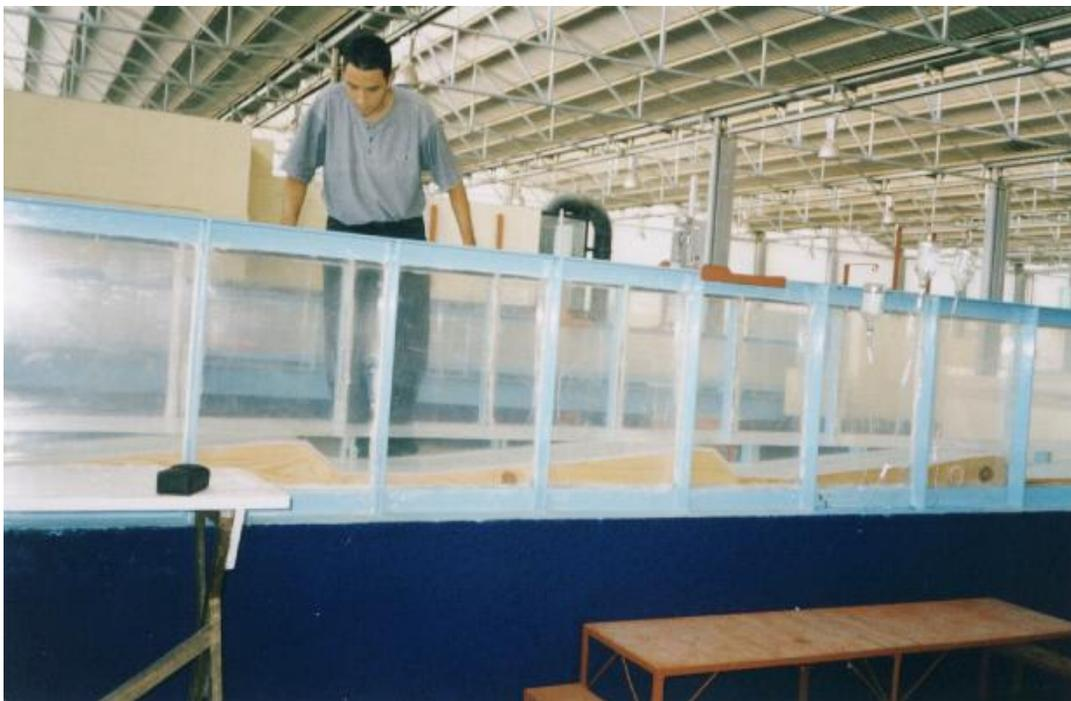
Figura II.1.2 b) Dunas sobre “tarrajas” se madera cubiertas con lámina de acrílico.
