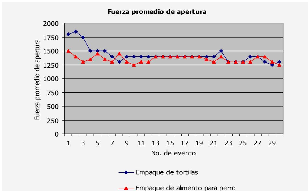
Fig. VI.6.- Gráfica de la aplicación de fuerzas requerida para la apertura de empaques.
