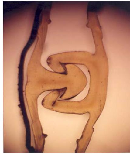
Fig.V.3.- Elemento resellable con cabeza simétrica.
