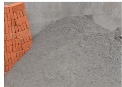
**2.3.2 Muestreo del agregado.** El muestreo del material almacenado se hizo como lo indica la norma mexicana NMX-C-030-1997-ONNCCE “Agregados-Muestreo” en su inciso 6.3.8. La cantidad en peso de la muestra compuesta fue suficiente para realizar las pruebas de laboratorio consideradas.
