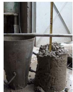
Fig.26. (Derecha). Prueba de revenimiento.
