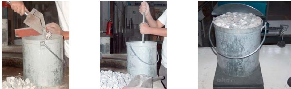
**Figuras 12, 13 y 14 Determinación de la masa suelta y compacta del agregado grueso (grava)**
