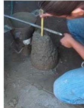
Fig. 21. Prueba de revenimiento
