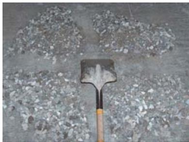
**Fig.05 Reducción de la grava método B**
