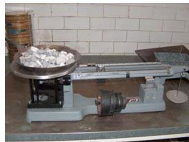
**Fig.08 Pesado del retenido parcial de grava**
