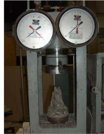
Fig.32. (Derecha). Residuos de un espécimen ensayado a compresión simple. Como puede observarse, la preparación del espécimen y la aplicación de la carga fueron adecuados.
