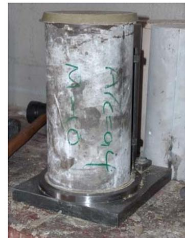
Fig.30. (Derecha). Espécimen con mortero azufre-arena del No.100 en proporción 60-40 en peso. La fotografía corresponde al espécimen No. 10, relación A/C = 0,4 y cemento CPO 40R/ B.
