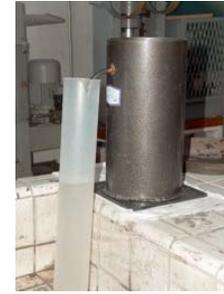
Fig.16. (Derecha) Recolección del volumen desalojado por la masa de la muestra llevada previamente a su estado saturado superficie seca.
