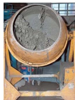
**Fig.20. Mezclado del concreto**
