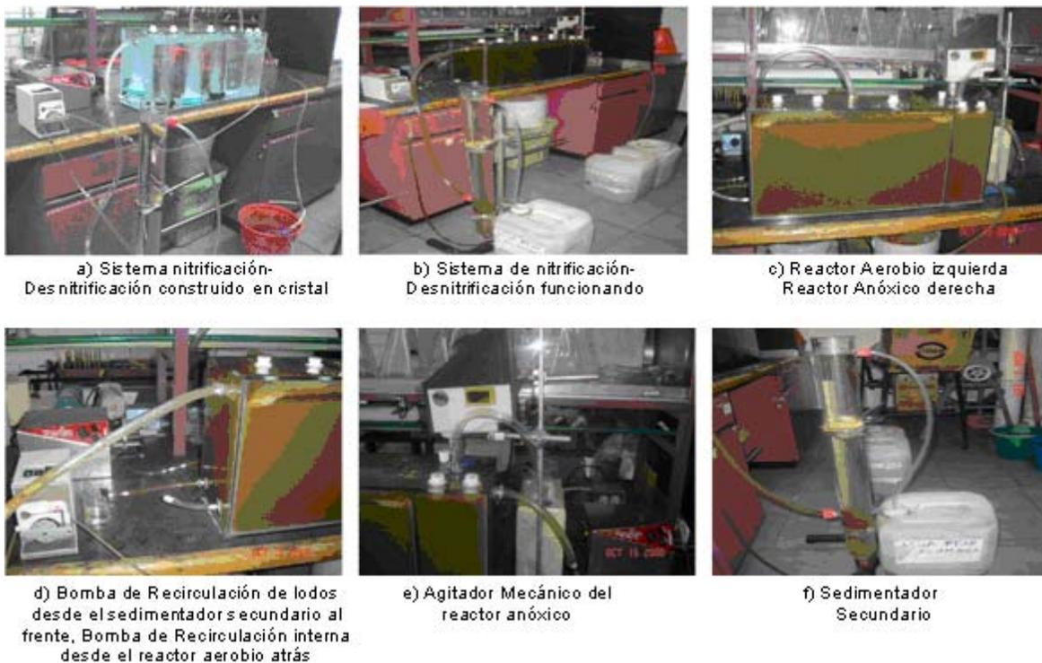
**Figura 28. Sistema biológico para degradación de aminas gastadas**
