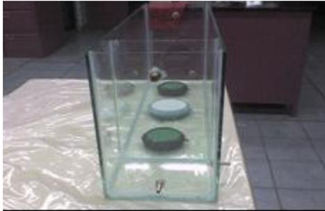
**c) Sistema de aireación utilizando difusores de burbuja fina**
