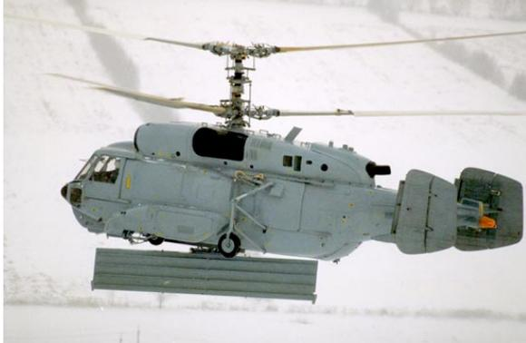
**Fig. 4.16- Radar de alerta temprana E-801M OKO (ojo) que fue desarrollada por el “Nizhny Novgorod Radio Engineering Institute” de Rusia . Cuenta con una antena giratoria abatible [www.airforce-technology.com/projects/ka3].**
