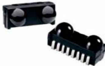
Figura III.21. Transceptor óptico.
