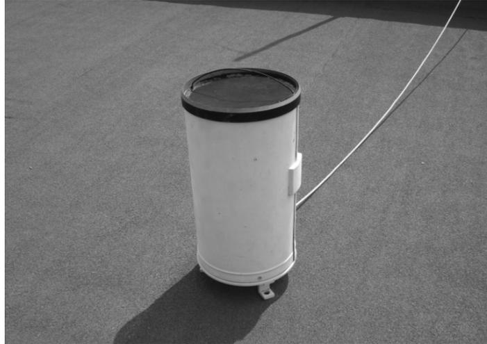
*Figura IV.8. Pluviómetro tipo balancín.*
