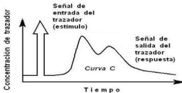
Figura 17. Curva respuesta de un estudio de trazado
