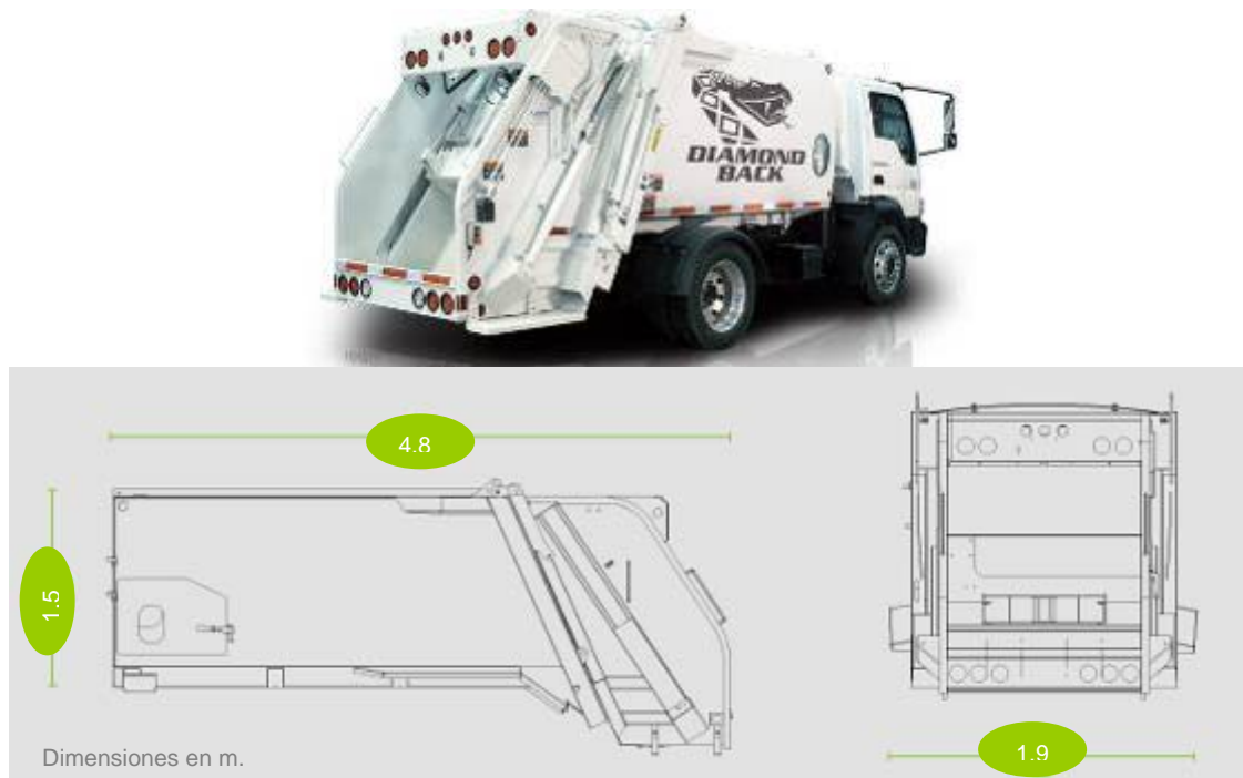
Figura 35. Vehículos de recolección con levanta contenedores.
