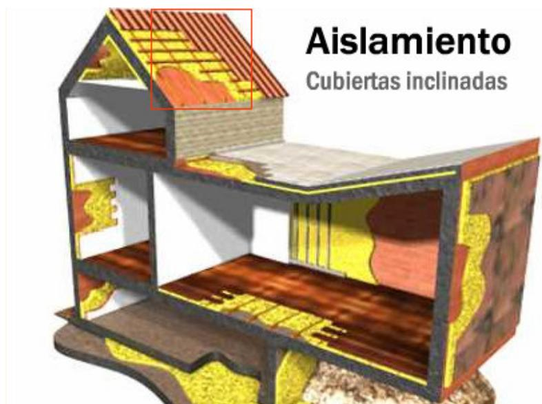
Figura III.5 Aislamiento de espuma de poliuretano<sup>10</sup>
