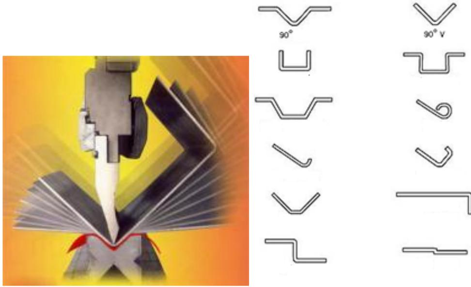
**FIGURA 7.25** Ejemplos de perfiles obtenidos en la prensa de cortina
