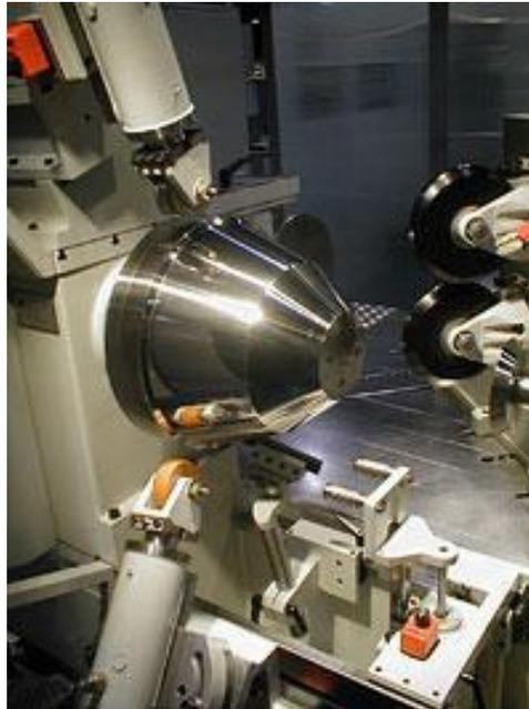
**FIGURA 7.13** La operación de rechazado se realiza al empujar la lámina mediante una o varias herramientas sin filo, sobre el mandril; el cual se encuentra girando
