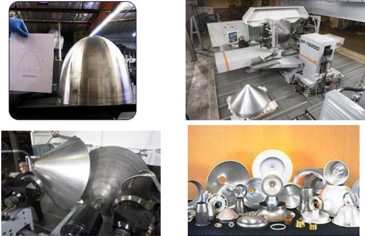
FIGURA 7.15 Ejemplos de formado mediante rechazado
