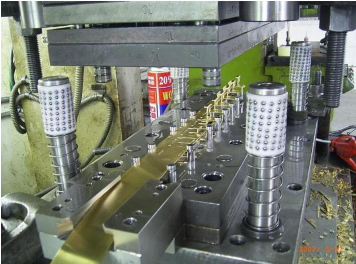
**FIGURA 7.33** Troquel progresivo de 10 etapas para alta producción. Nótese que las guías ya no emplean bujes sino sistemas antifricción
