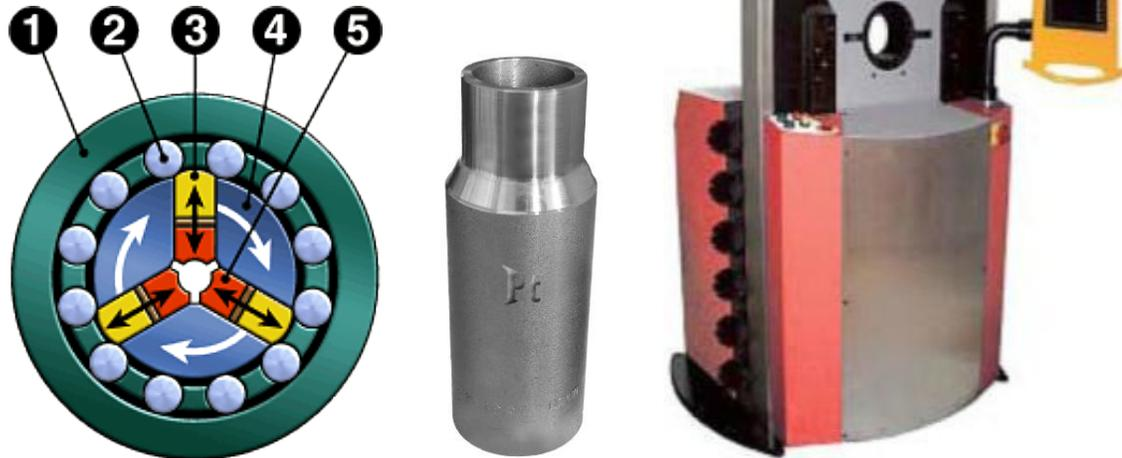
**FIGURA 7.19** En la imagen de la izquierda se muestra esquemáticamente la operación de una suajeadora rotatoria, en la imagen del centro se presenta un niple producido por suajeado; mientras que en la de la derecha se observa un equipo hidráulico para suajeado
