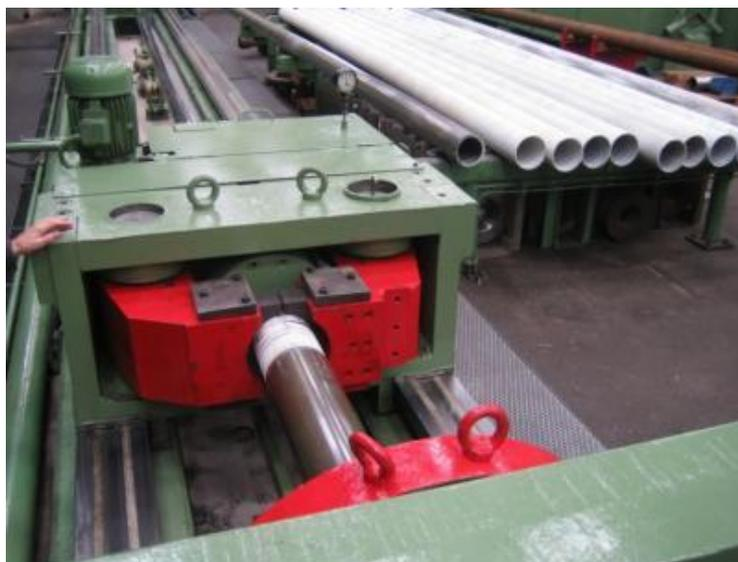
**FIGURA 7.11** Mesa hidráulica de estirado para tubo
