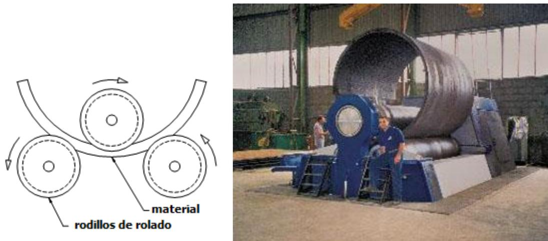
**FIGURA 7.24** En la imagen de la izquierda se muestra esquemáticamente el proceso de relado de chapa metálica; a la derecha se presenta una roladora mecánica para placa de 10 a 35 mm de espesor y hasta 4 m de ancho
