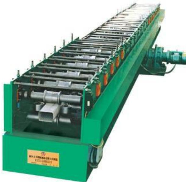
**FIGURA 7.22** Formado por rodillos de perfiles tubulares
