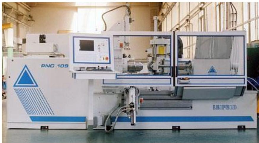
**FIGURA 7.14** Torno de CNC para rechazado
