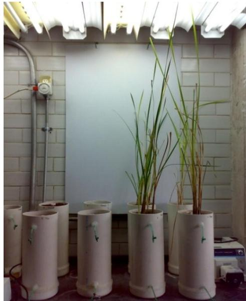
Figura 3.2 Sistemas de humedales artificiales a utilizar durante la fase experimental
