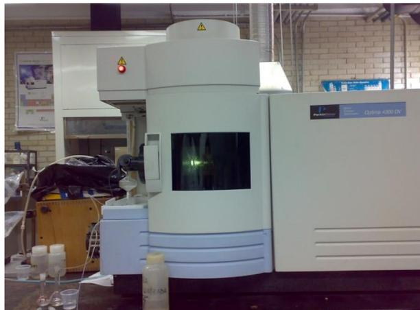
**Figura 3.7** Equipo de espectrofotometría inducida con plasma
