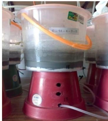
**Figura 3.3 Celdas de humedad a escala piloto (*González-Sandoval, 2008*)**
