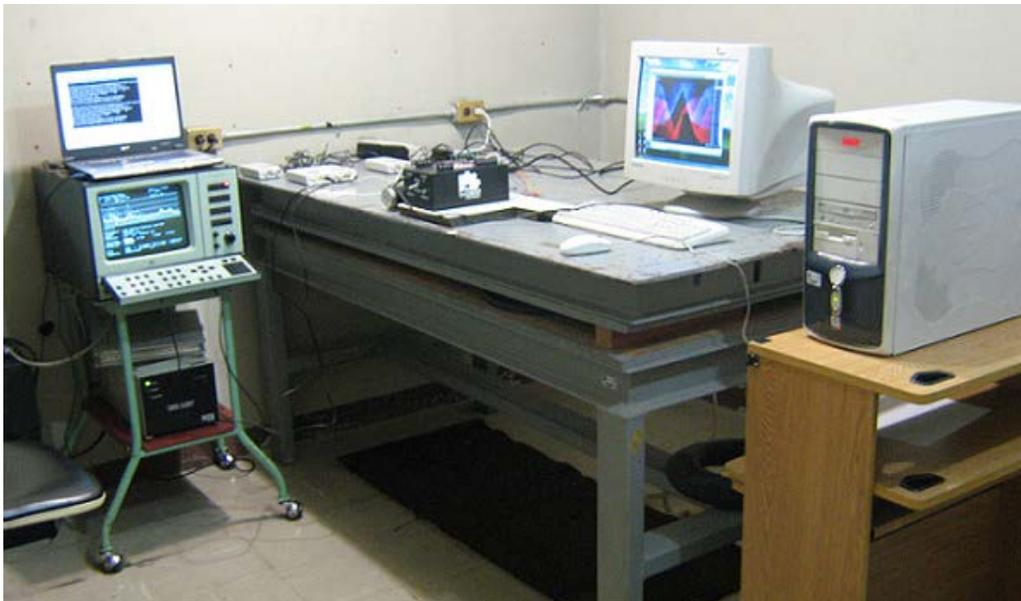
Fig. 5.6 Mesas de trabajo separadas para evitar vibraciones ajenas a los motores
