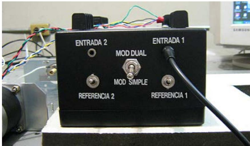
Fig. 5.3 APO conectado en una entrada, puesto en modo SIMPLE y sobre una base de espuma
