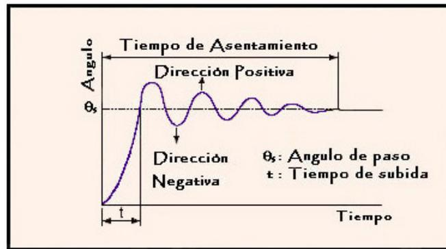
Fig. 3.2 Respuesta de posición a un solo paso
