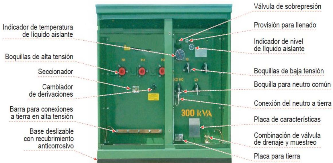
Figura 7.5 Transformador tipo pedestal de frente muerto.
