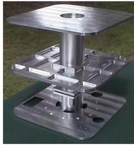
*Figura 1.4. Estructura de aluminio de SATEX.*
