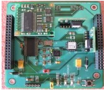
Figura 1.12. Subsistema de Sensores de Estabilización
