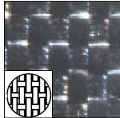
FIG. 2.3 ESTRUCTURA DEL GEOTEXTIL TEJIDO
