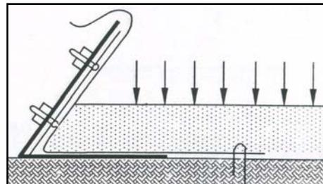
FIG. 3.17 ESQUEMA DE COLOCACIÓN DEL MATERIAL DE RELLENO
