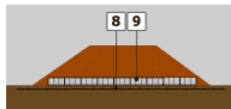
FIG. 3.25 ESQUEMA DE TERRAPLÉN CON SISTEMA DE DRENAJE Y REFUERZO EN LA BASE. 8 GEOMALLA BI-ORIENTADA; 9 SISTEMA DE GEOCOMPUESTOS
