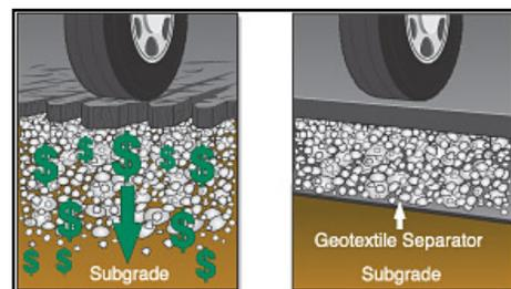
FIG. 3.6 FUNCIÓN DE SEPARACIÓN DEL GEOTEXTIL ENTRE LA SUBRASANTE Y EL AGREGADO
