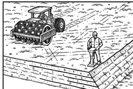
FIG. 3.18 ESQUEMA DE COMPACTACIÓN DE LAS ORILLAS CON EQUIPO MANUAL Y EL CENTRO CON MAQUINARIA PESADA
