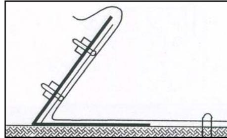
FIG. 3.15 GEOSINTÉTICO ANCLADO AL SUELO Y SUJETADO A LA CIMBRA
