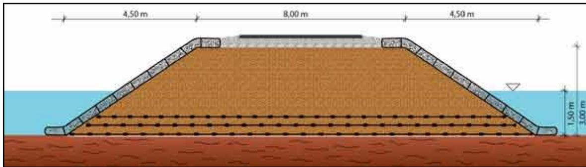
Los colchones de gavión utilizados en los hombros y taludes laterales se instalaron en zonas sujetas a la presencia de mareas, para eliminar los efectos erosivos que las corrientes hubieran provocado. El total de geomallas instaladas en conjunto, fue alrededor de 400,000 m<sup>2</sup>.
