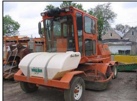
**FIG. 3.8 BARREDORA CON TANQUE DE AGUA AL FRENTE**
