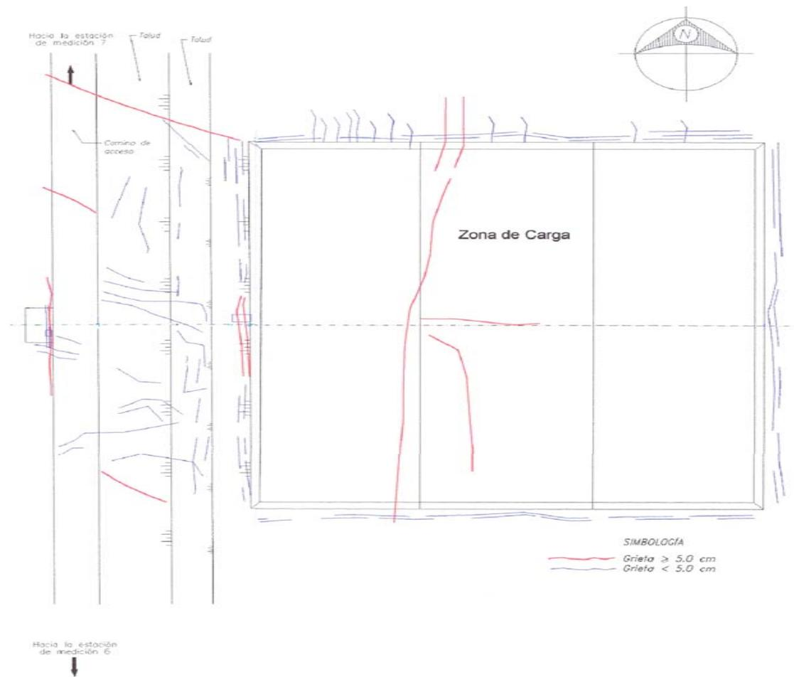
Figura 3.39. Patrón de agrietamiento en la zona de carga (TGC 2004)
