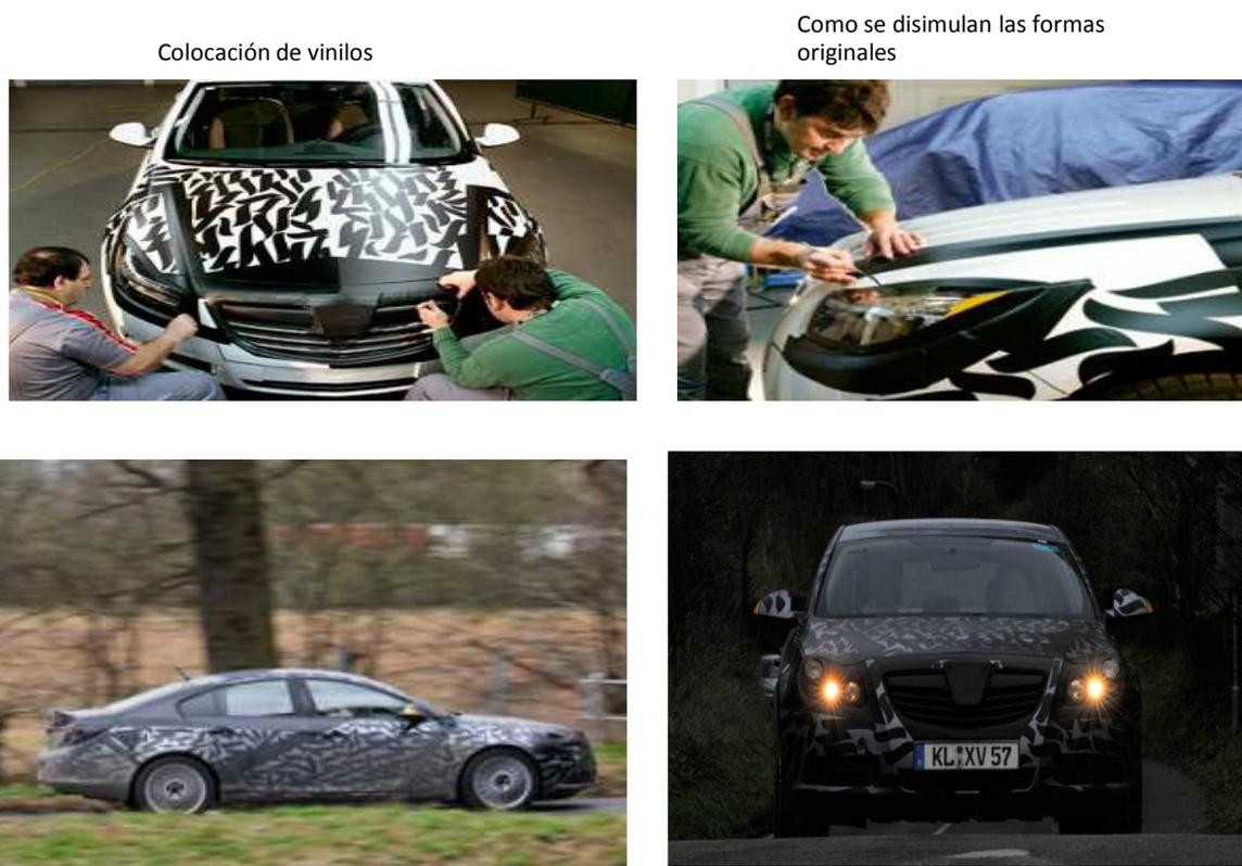
Figura 14. Camuflaje de vehículos prototipo.
