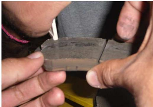
Figura 19. Medida de desgaste en balatas.
