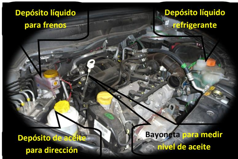
Figura 12. Identificación de depósitos para fluidos en el vehículo.
