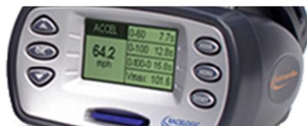
Un motor GPS a 10Hz desarrollado usando el LabSat de Racelogic proporciona gran precisión en todas sus mediciones. Con almacenamiento en memoria extraíble SD, instalación en segundos, facilidad de uso, software para análisis de datos incluido, pantalla LCD retro iluminada, comunicación USB, antena GPS interna/externa, el DriftBox es una herramienta para un gran número de aplicaciones a un precio muy accesible.
