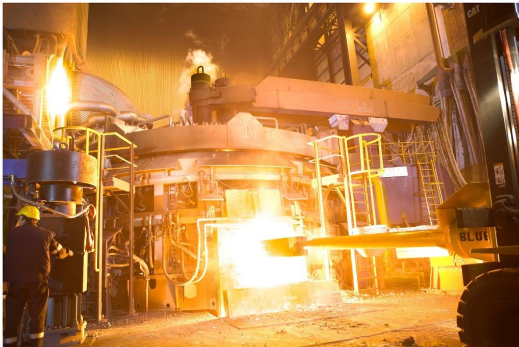
**Figura 17. EAF durante un proceso de fabricación, se puede ver el color rojo vivo de los gases.**
