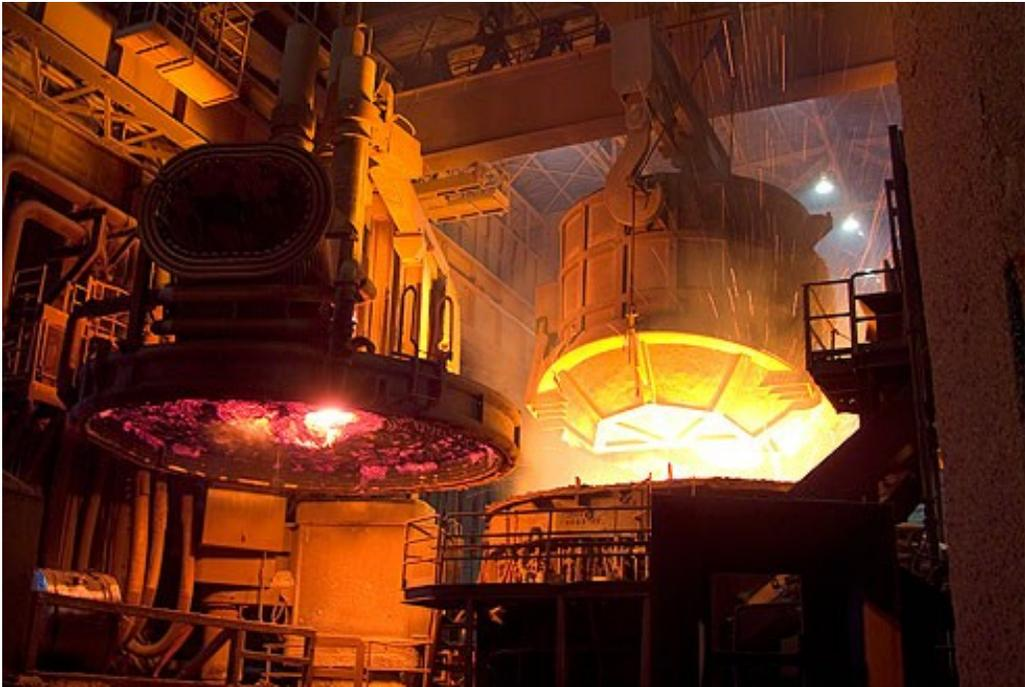
**Figura 6. Olla de chatarra cargando material.**
