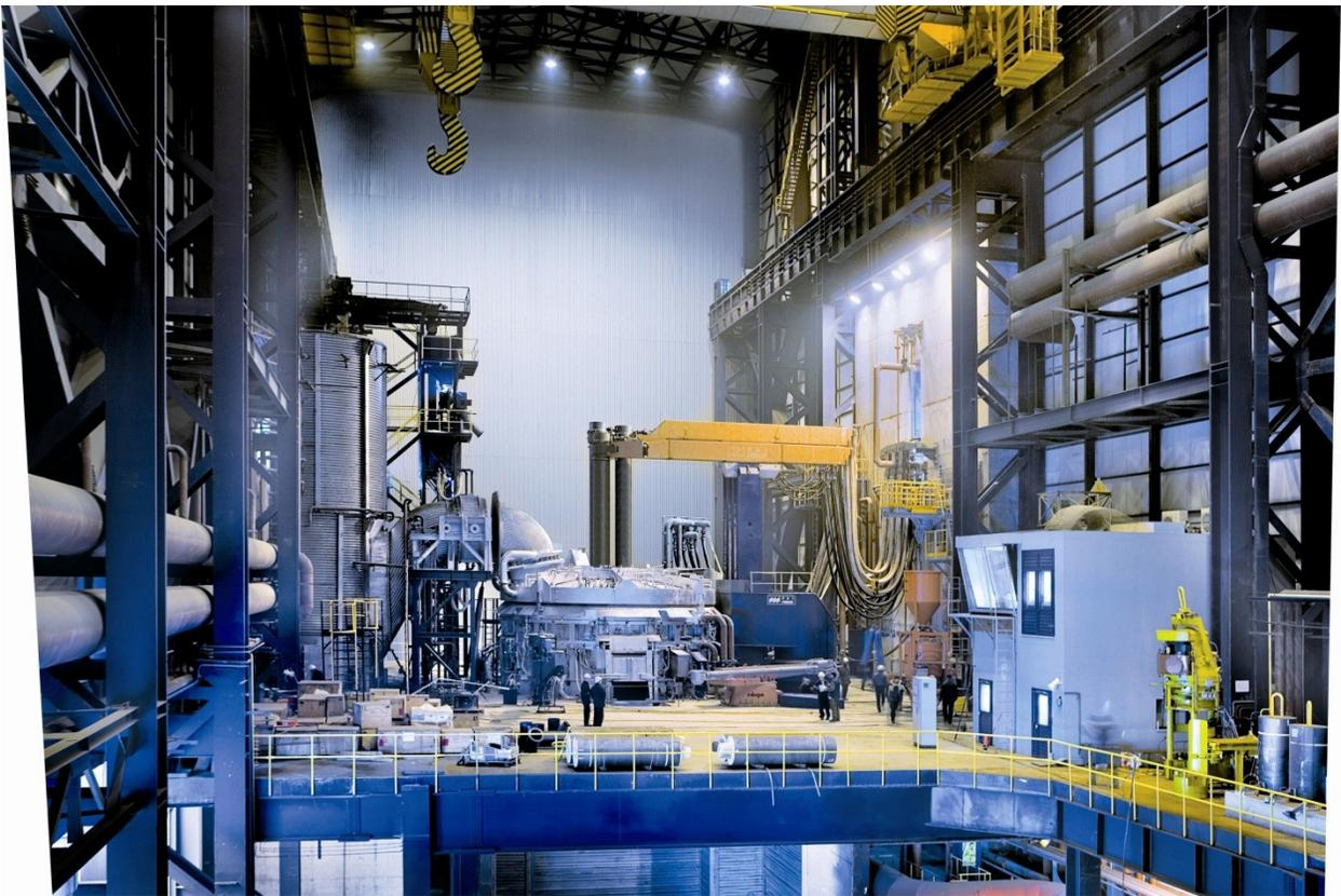
**Figura 1. Acería Carinox, Bélgica. Horno de arco eléctrico Siemens con una capacidad de producción de 160 toneladas por colada.**
