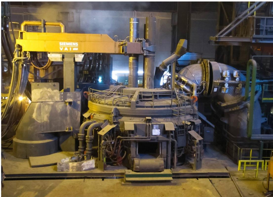
**Figura 3. Horno de arco eléctrico (EAF).**
