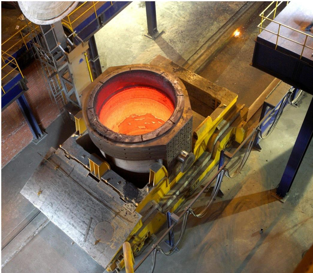
**Figura 7. Carro de transferencia con olla de colada de LF.**
