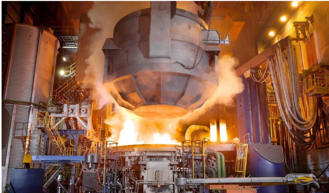
**Figura 5. Olla de chatarra a punto de ser descargada en un EAF.**
