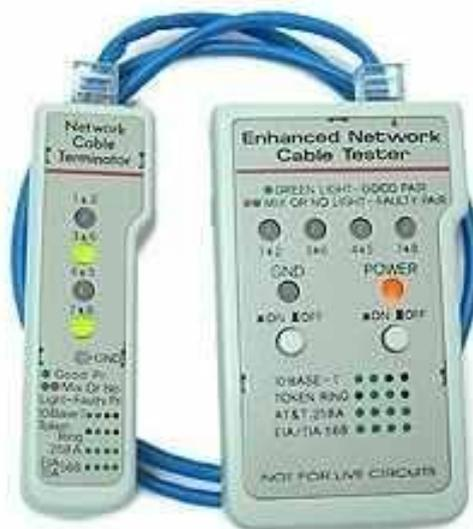
**Figura 3.44 Probador de cables**
