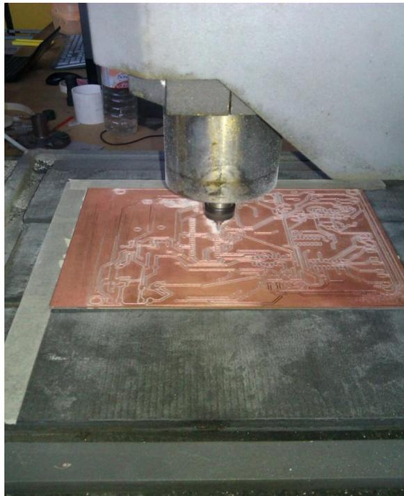
Figura 3.14.- Máquina CNC.
