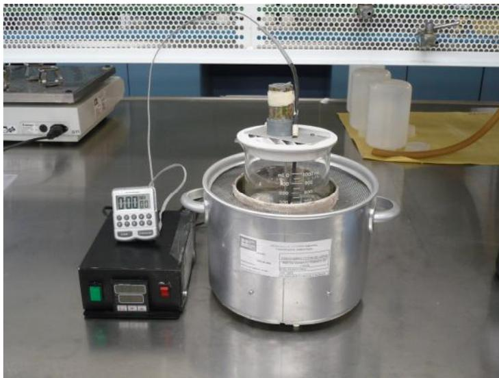
**Figura 6.2** Termohidrolizador de lodos utilizado en la experimentación.
