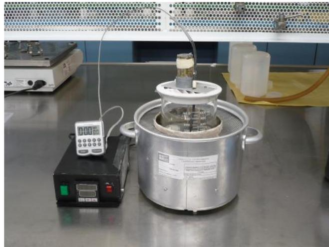
Termohidrolizador de lodos
