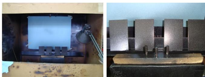
Figura III.14 Pintado de las probetas planas y cilíndricas.
