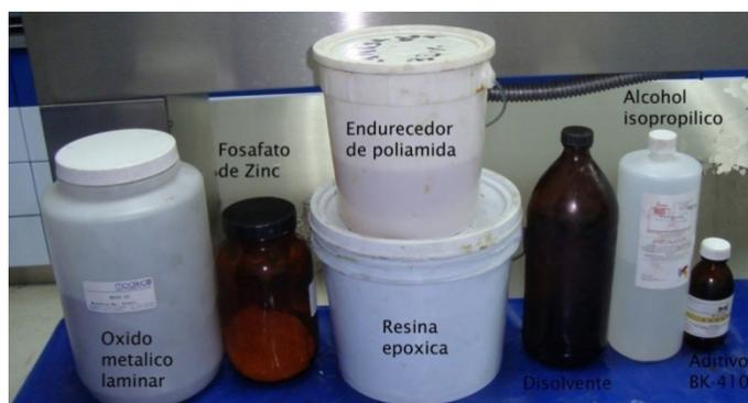
Figura III.11 Componentes utilizados para la elaboración de los 11 sistemas de pintura.
