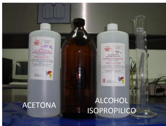
Figura III.10 Preparación del disolvente 63 % alcohol isopropílico/37% acetona.
