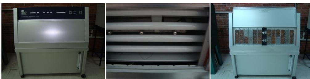
Figura III.17 Máquina para la prueba de intemperismo acelerado *Q-Panel QUV*.
