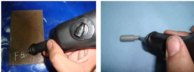
Figura III.3 Identificación de las probetas cilíndricas y planas.
