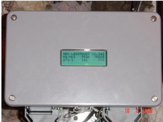
Figura 3.6. Medidor de partículas
