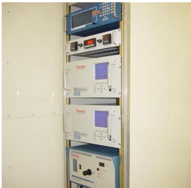
Figura 3.9. Medidor de óxidos de nitrógeno
