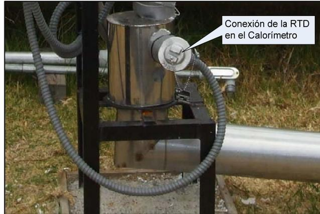
Figura 4.16. Conexión de la RTD en el Calorímetro.
