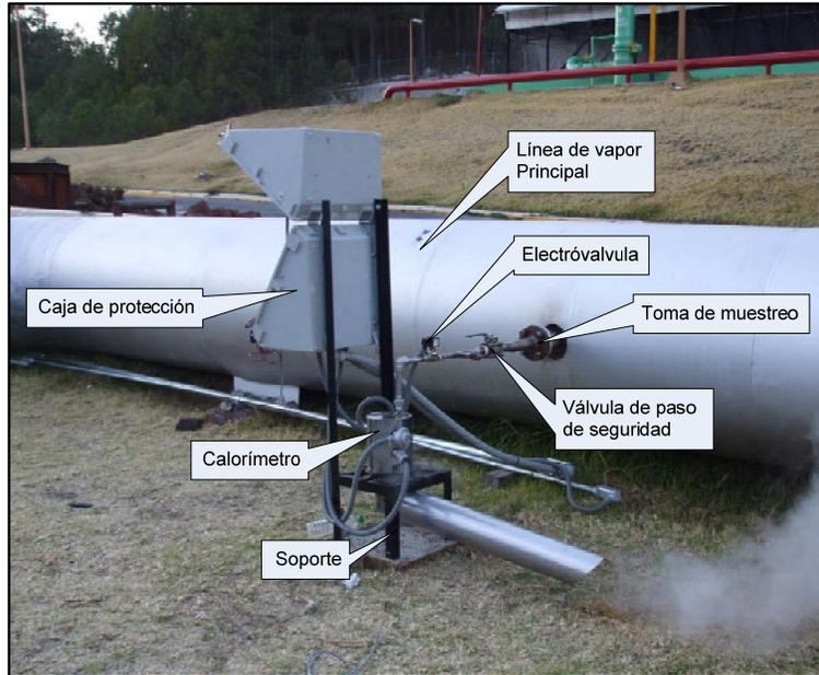
Figura 4.13 Instalación del calorímetro en sitio.
