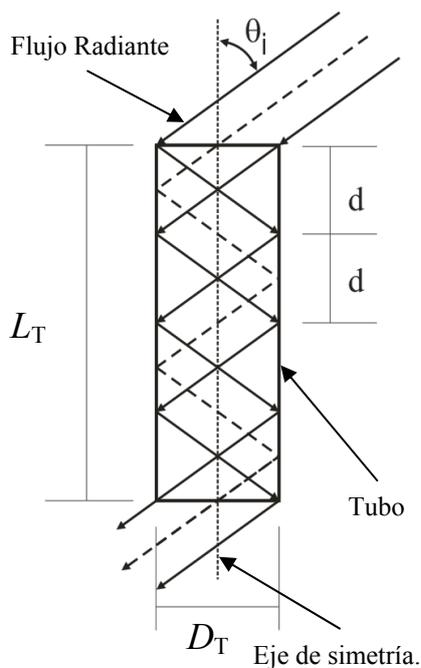
Figura 5.4 Esquema de un *Lightpipe*.
