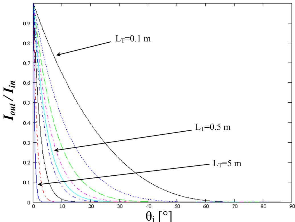
Figura 5.6 Curvas de la transmitancia de un tubo (Ec. 5.1) donde los valores para  $D=12.5$  mm,  $R=0.8$ , y una  $L_T$  de 0.1, 0.2, 0.3, 0.4, 0.5, 0.6, 1, 2 y 5 m. Cada línea en la gráfica sigue el orden de derecha a izquierda para cada valor de  $L$  considerado.
