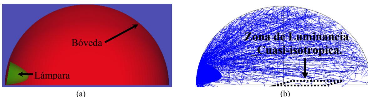
Figura. 4.3 Bóveda de caracterización: (a) Esquema de la bóveda, (b) trazo de rayos para observar el comportamiento de la bóveda y la Zona de Luminancia Cuasi-Isotrópica.
