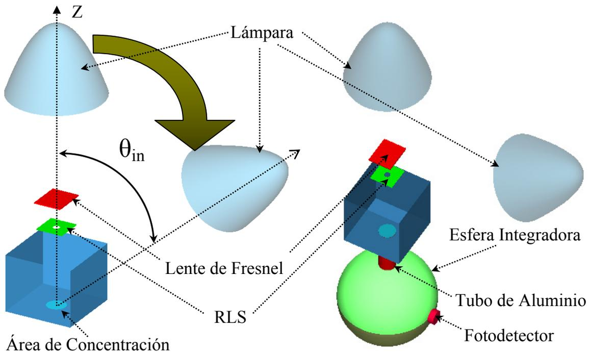
Fig. 5.7 Sistema de caracterización para los SCLL.
