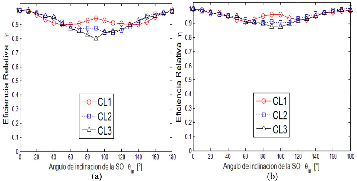
Figura 4.11 Gráfica de la eficiencia relativa de la CL's en función del ángulo de inclinación de una Superficie Obstructora de 6x6 cm a una distancia de: (a) 8 cm y (b).12cm
