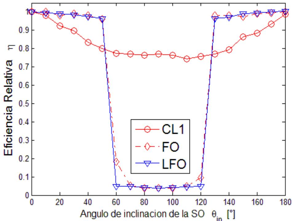
Figura 4.14 Gráfica comparativa de la eficiencia relativa del sistema FO, LFO y CL1 en función del ángulo de inclinación de una SO 12x12 cm a una distancia de 8 cm.
