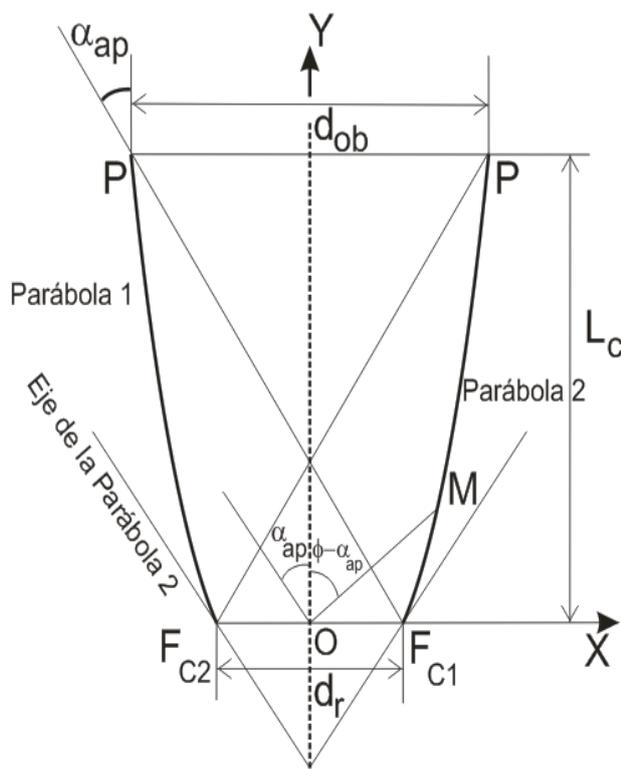
Figura 3.3 Esquema de un concentrador parabólico compuesto CPC.
