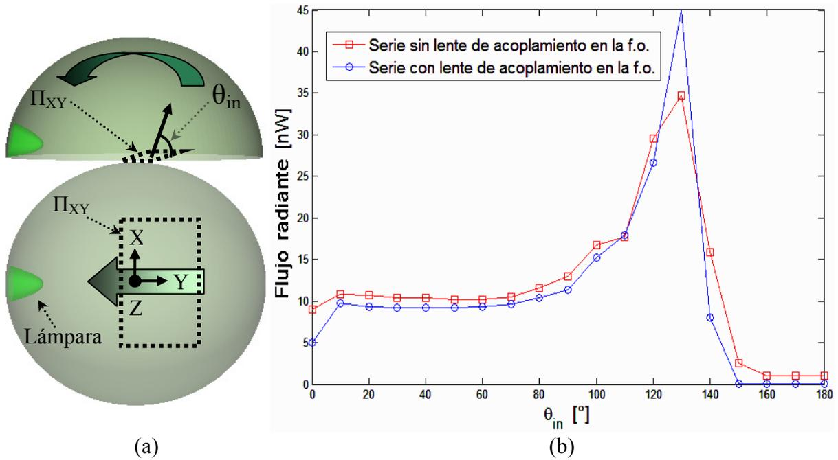
Figura. 4.6 (a) Diagrama para describir los barridos azimutales sobre el  $\Pi_{YZ}$  respecto al plano XY. (b) Gráficas del flujo radiante capturado como función del ángulo de inclinación  $\theta_{in}$ .
