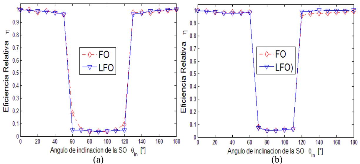
Figura 4.12 Gráfica de la eficiencia relativa del sistema FO y LFO en función del ángulo de inclinación de una Superficie Obstructora de 12x12 cm a una distancia de: (a) 8 cm y (b).12cm
