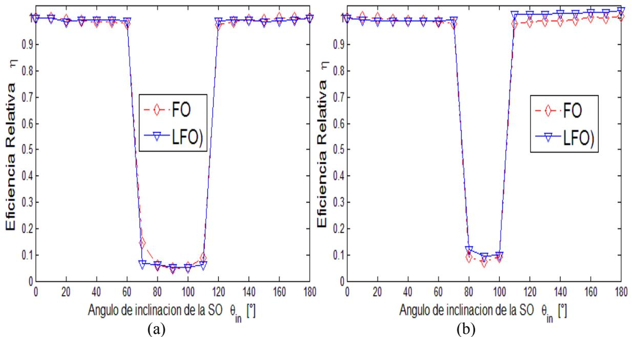
Figura 4.13 Gráfica de la eficiencia relativa del sistema FO y LFO en función del ángulo de inclinación de una Superficie Obstructora 6x6 cm a una distancia de: (a) 8 cm y (b) 12cm.
