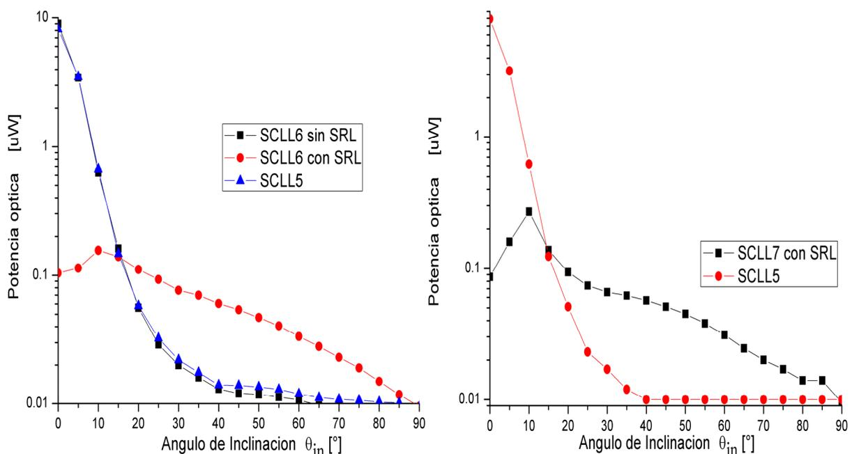
Figura 5.16 Gráfica de la potencia óptica capturada por los sistemas SCLL6 y SCLL7. El diámetro del tubo es de 1.25 cm y tienen longitudes de 40 cm.
