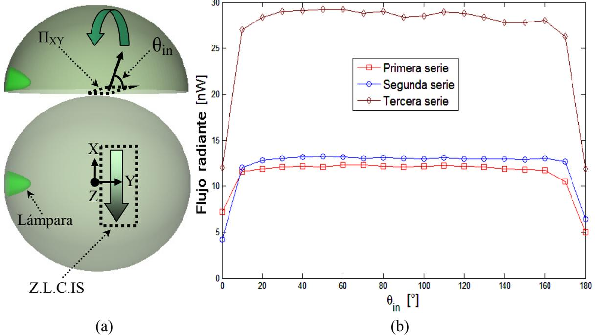
Figura. 4.5 (a) Diagrama para describir los barridos azimutales sobre el  $\Pi_{XZ}$  respecto al plano XY. (b) Gráficas del flujo radiante capturado como función del ángulo de inclinación  $\theta_{in}$ .
