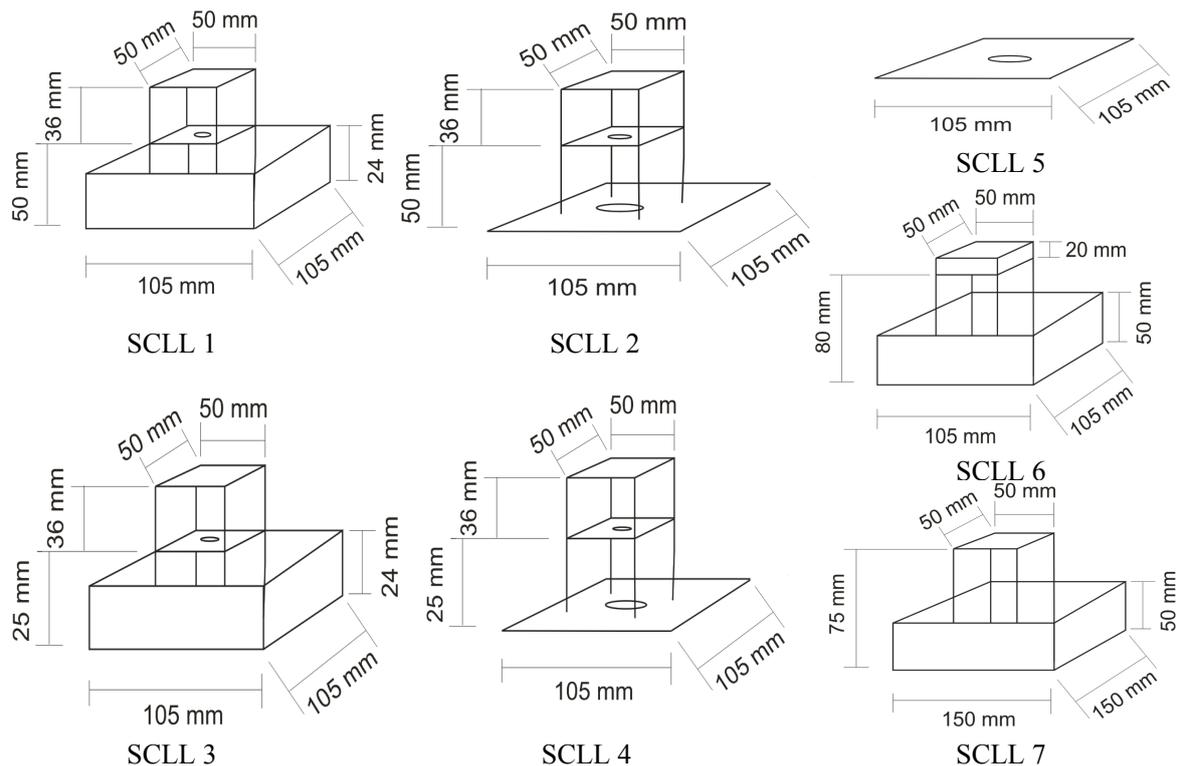
Figura 5.2 Sistemas Colectores de Luz Lambertianos propuestos para coleccionar radiación directa y radiación difusa. Solo de la SCLL1-SCLL4 poseen una lente de Fresnel en la parte superior.
