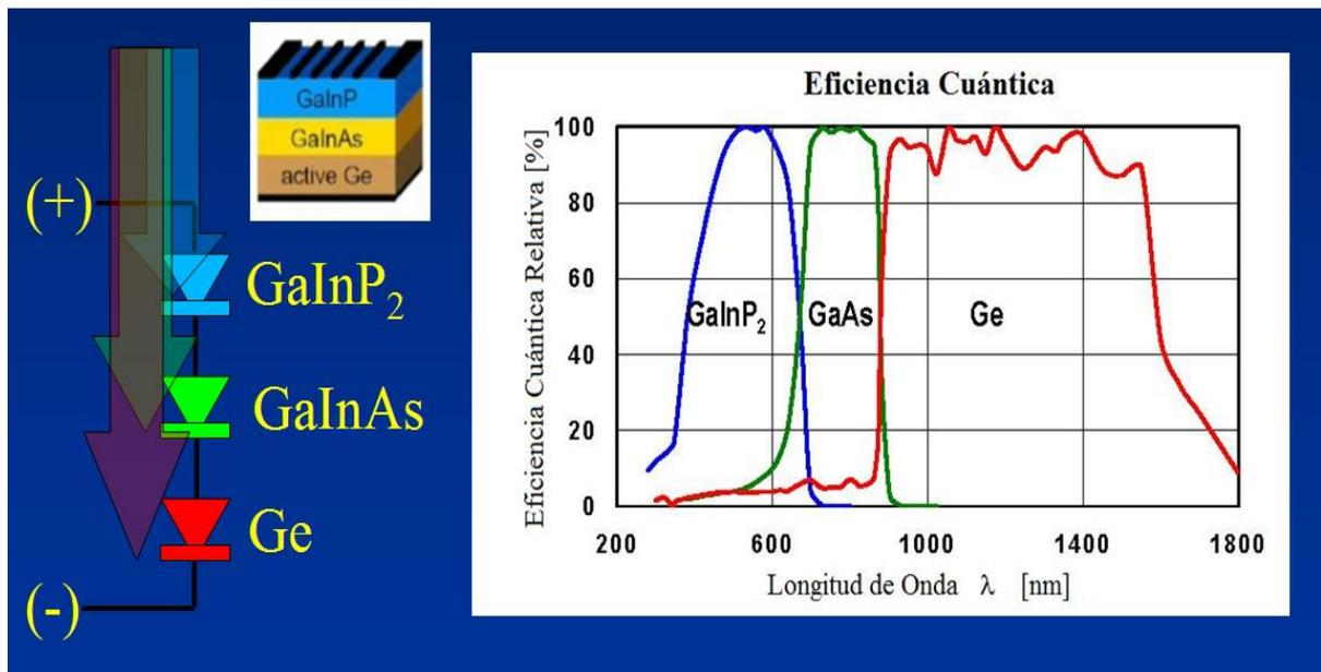
Fig. 1.4 Esquema y espectro de absorción de una celda fotovoltaica (PVC)
