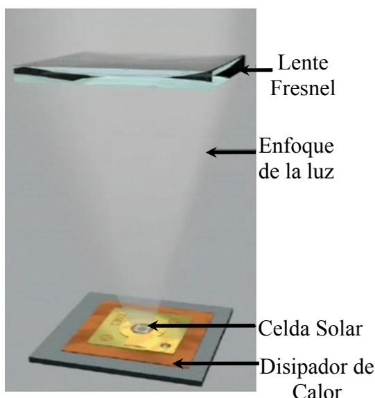
Fig. 1.5 Sistema lente Fresnel-PVC
