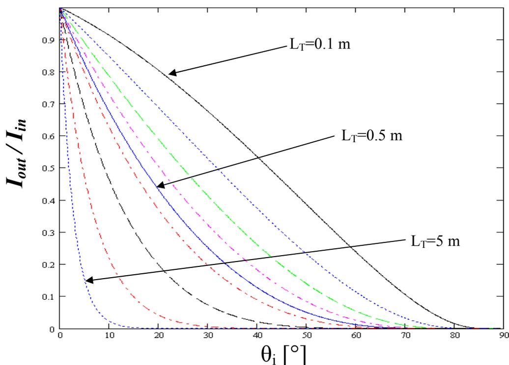
Figura 5.5 Curvas de la transmitancia de un tubo (Ec. 5.1) donde los valores para  $D=12.5$  mm,  $R=0.9$ , y una  $L_T$  de 0.1, 0.2, 0.3, 0.4, 0.5, 0.6, 1, 2 y 5 m. Cada línea en la gráfica sigue el orden de derecha a izquierda para cada valor de  $L$  considerado.
