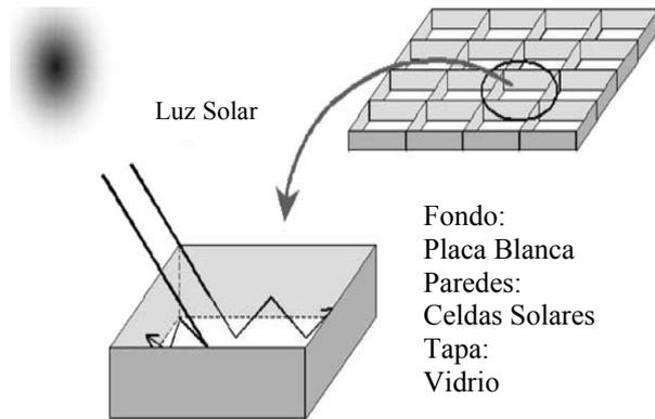
Figura 3.4 Arreglos de celdas fotovoltaicas utilizando como fondo una superficie blanca con la finalidad de aumentar su eficiencia.
