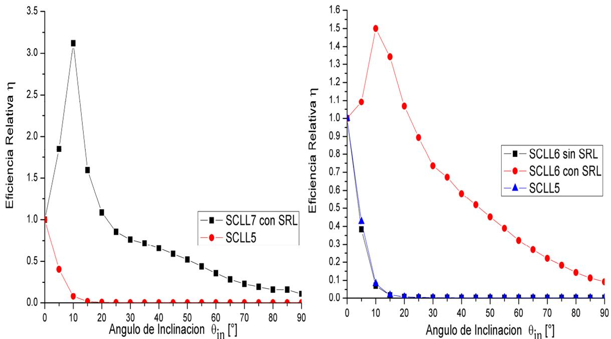
Figura 5.15 Gráfica de la eficiencia relativa para los sistemas SCLL6 y SCLL5. El diámetro del tubo es de 1.25 cm y tienen longitudes de 40 cm.
