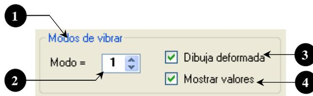
Figura 4.23 Controles para ver los modos de vibrar
