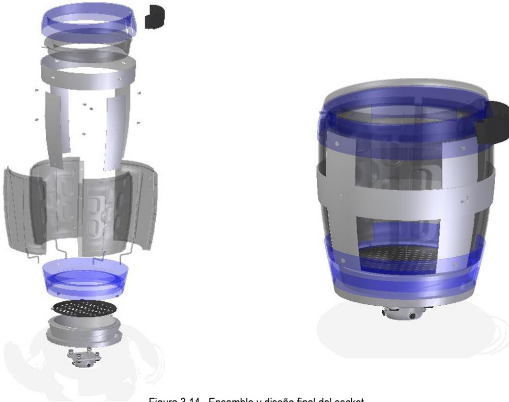
Figura 3.14. Ensamble y diseño final del socket.
