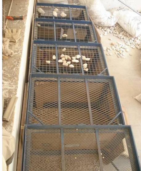
**Figura 2.2** Rejilla utilizada para el cribado de gravas.
