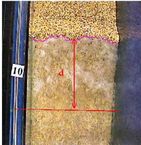
Figura 3.9 Estimación del run up experimental.
