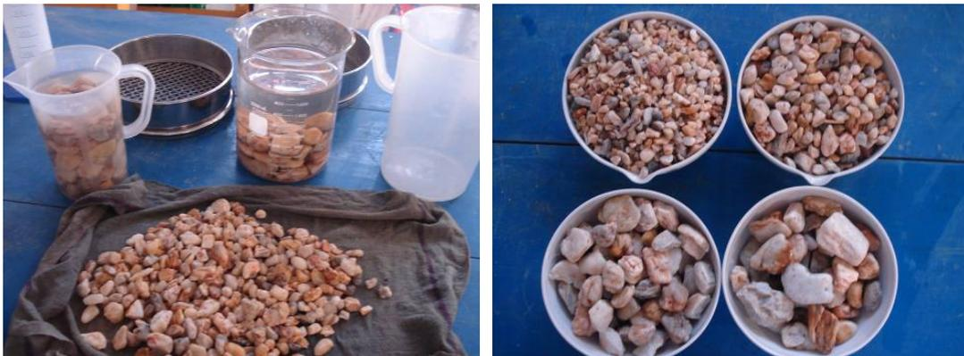
**Figura 2.3** Proceso de obtención de la densidad de las gravas.
