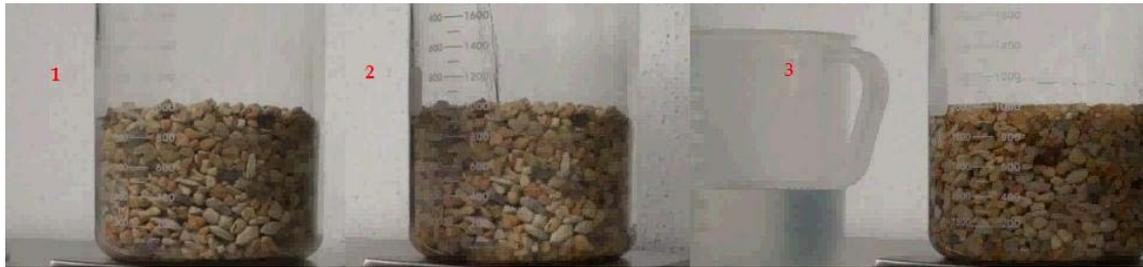
Figura 2.7 Determinación de la porosidad en el laboratorio.
