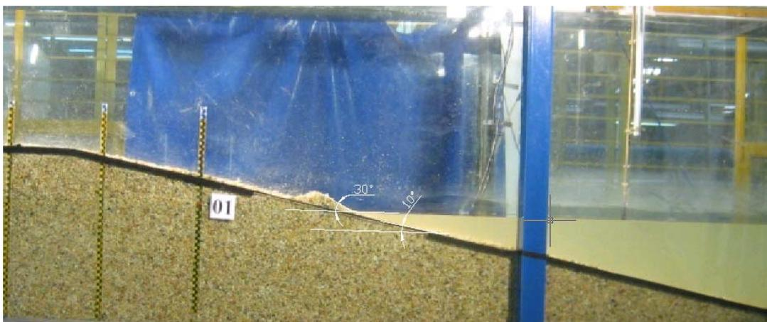
Figura 3.16 Pendientes posibles a utilizar para el cálculo el número de Iribarren.
