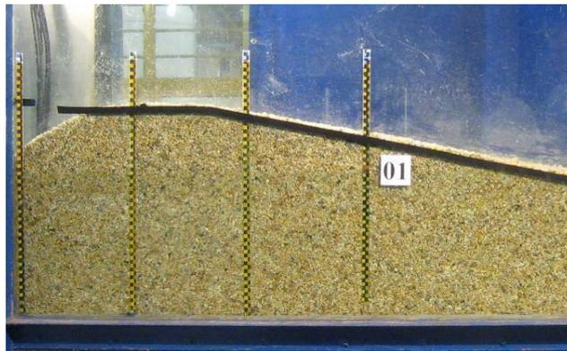
**Figura 2.15** Ubicación de los piezómetros dentro de la playa.
