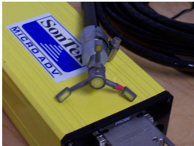
Figura B. 7 ADV Velocímetro Acústico
