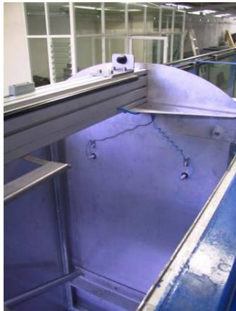
**Figura B. 2** Generador de oleaje (Instituto de Ingeniería, UNAM)
