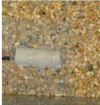
**Figura 2.14** Sensor de presión colocado en la playa sobre una malla.
