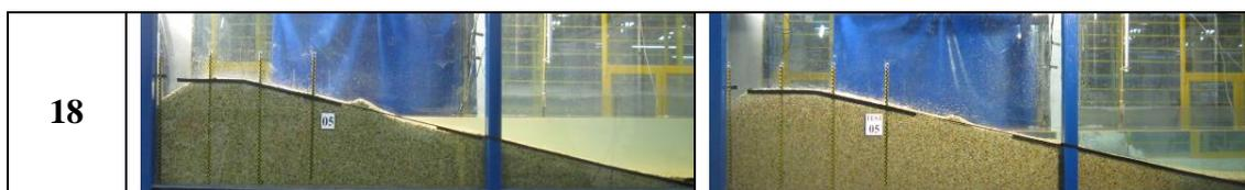
En las imágenes de la Tabla 10 pareciera que no existen diferencias importantes en la forma de los perfiles estables, sin embargo, sí es notorio que los ensayos del caso 2 presentan una zona de erosión justo debajo del nivel de agua en reposo más marcada que los perfiles del caso 1. Por otra parte, una observación a detalle permite destacar que el volumen de la berma de material desplazado es de mayor volumen en los perfiles del caso 1.
