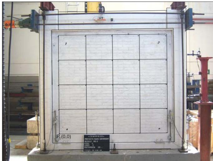
Figura 3.36. Superposición de la imagen con el dibujo del muro, haciéndolos coincidir en el Punto  $P_1(0,0)$ .
