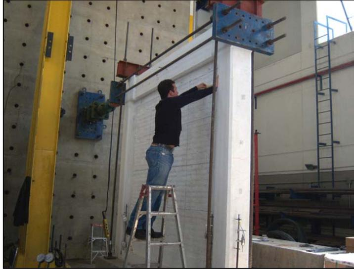
3.9. Medición de las dimensiones reales del muro.
