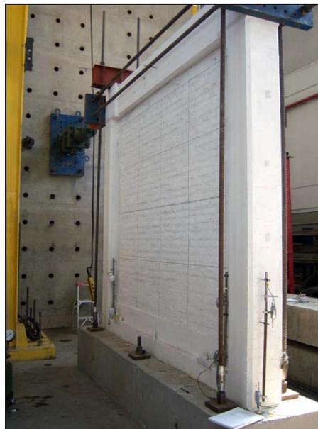
Figura 3.6. Vista lateral del muro, donde se observan al fondo, el muro de reacción y el gato de 100 ton.
