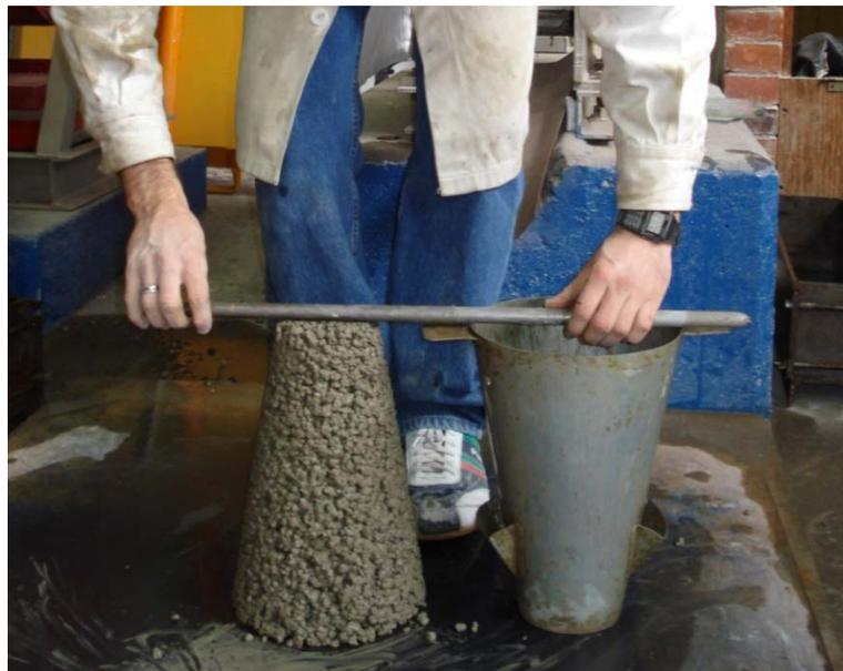
Figura 6.5 Revenimiento cero de la mezcla de concreto permeable de 3/8" con 15% de vacíos.
