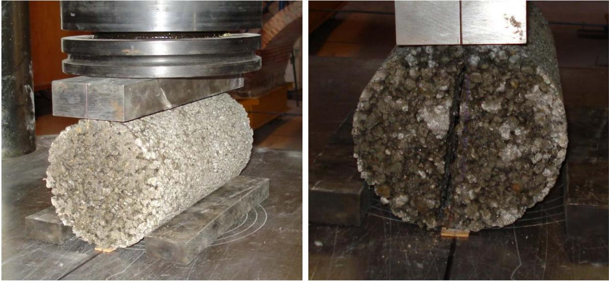
Figura 6.14 Ensayo de resistencia a tensión indirecta por compresión diametral.
