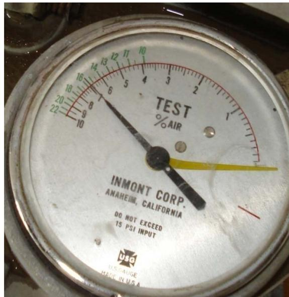
Figura 6.9 Resultado de la prueba de contenido de aire del concreto convencional con aditivo agente espumante (16%).
