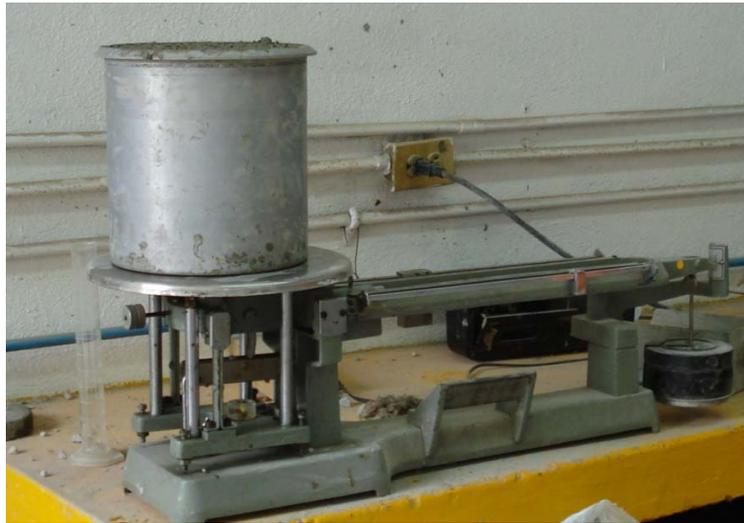
Figura 6.10 Equipo para la determinación del peso volumétrico.
