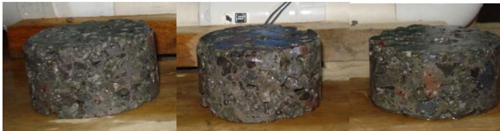
Figura 6.23 Muestras utilizadas para la prueba de permeabilidad.
