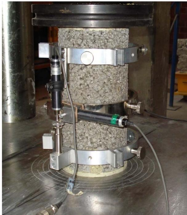
Figura 6.19 Ensaye de módulo de elasticidad.
