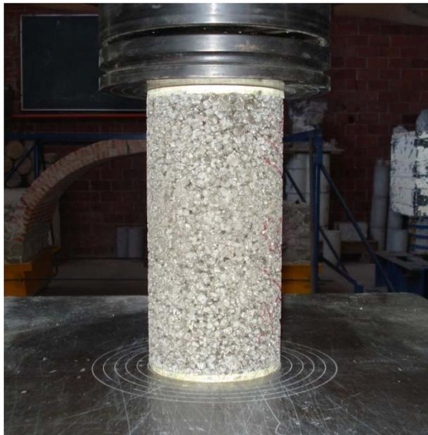
Figura 6.11 Ensaye de resistencia a compresión.
