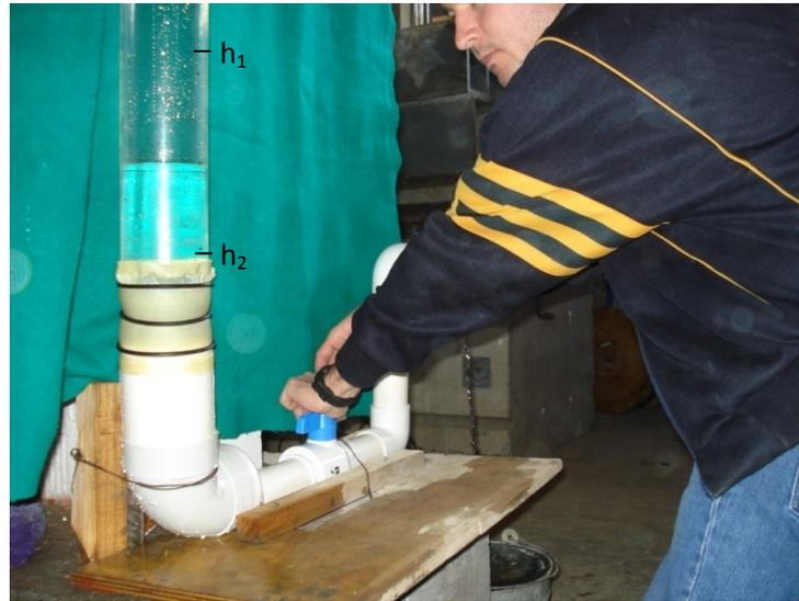
Figura 6.22 Prueba de permeabilidad.
