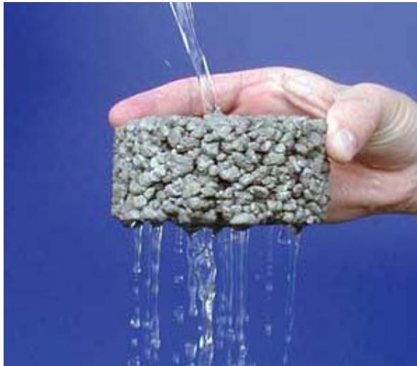
Figura 1.1 Textura de una muestra de concreto permeable
