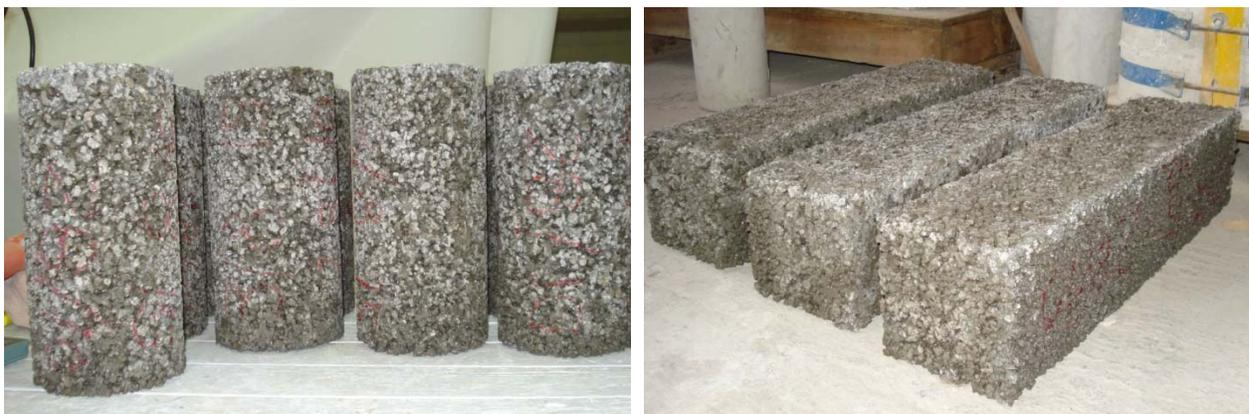
Figura 5.3 Cilindros y vigas de concreto permeable.
