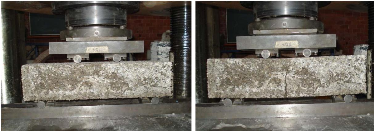
Figura 6.16 Ensaye de resistencia a flexión en base a la norma ASTM C78.
