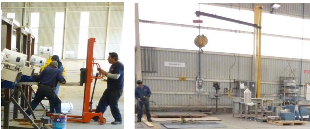
Figura 2.18 – Uso de patín hidráulico y polipasto en los procesos de ensamble.
