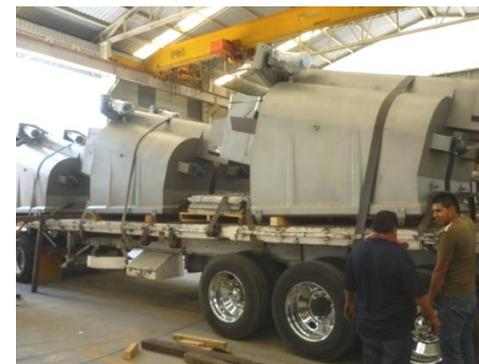
La forma de acomodar los equipos resultaba ser de acuerdo a sus dimensiones y geometrías y en la mayoría de las ocasiones se utilizaba el programa de diseño SolidWorks como apoyo para la ubicación de los equipos en la plataforma del transporte.
