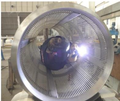
Figura 2.22 Soldadura de pieza de ensamble con proceso GMAW.
