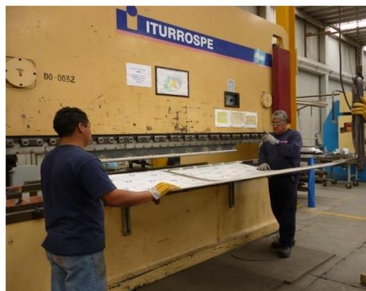
Figura 2.14- Dobladora ITURROSPE de control CNC.
