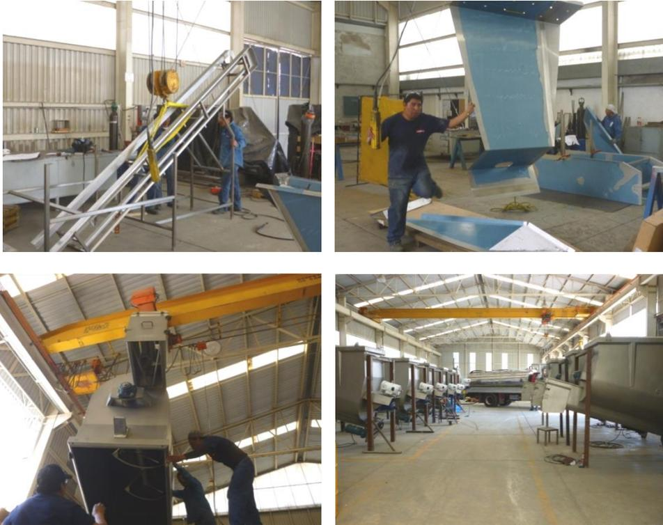
La grúa viajera es un excelente apoyo que se desplaza a lo largo y ancho de la nave de ensamble cubriendo una superficie de 900 m<sup>2</sup>, con una capacidad máxima de carga de cinco toneladas y puede elevar hasta seis metros. Su principio de funcionamiento se basa en el uso de la polea que es por donde pasa un cable de acero que se enrolla en un tambor al activar un motor de 5 HP por medio de un control manual con seis botones, dos para cada desplazamiento en X, Y y Z.
