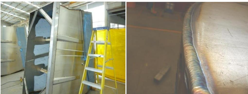
Otro grupo de trabajadores realizó el armado de las parillas de seguridad que se posicionaran en la parte superior de la máquina y que se realizan a partir de 67 varillas redondas de acero inoxidable de 5/8" de diámetro.
