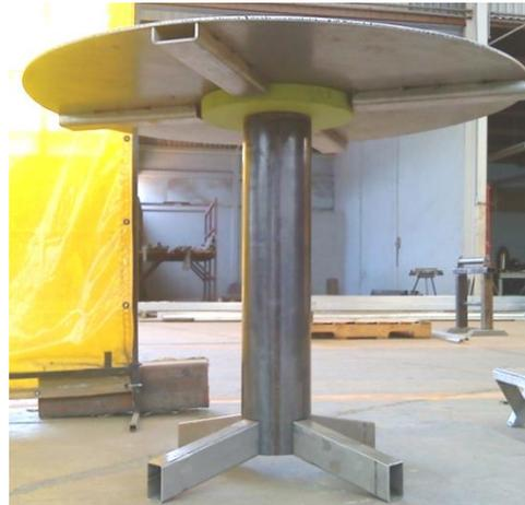
Las pruebas de funcionamiento se realizaron con éxito, se podía girar aplicando muy poca fuerza, se logró muy buena estabilidad y resultó ser muy cómoda y útil para los trabajadores que de inmediato utilizaron para diversas actividades en la fabricación de las máquinas.
