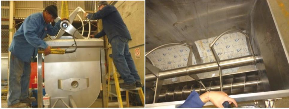
Los motores utilizados fueron inspeccionados por trabajadores de servicio técnico antes de ser colocados en los bunkers con el fin de encontrar roces del rotor o altibajos en el amperaje y voltaje marcados en la placa de datos.
