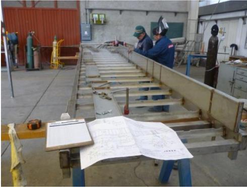
Figura 2.24- Uso de planos para la fabricación de máquina.
