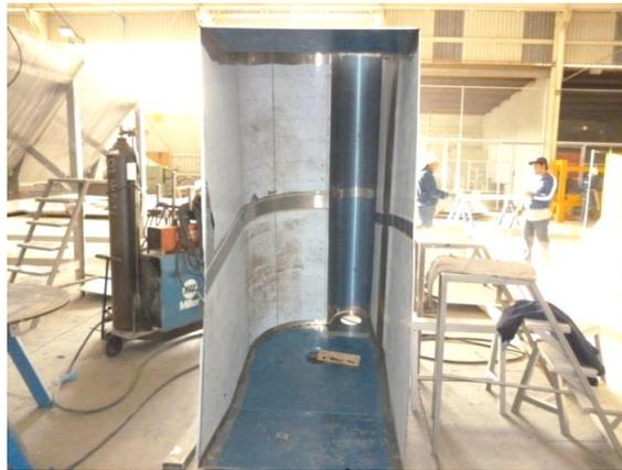
Mediante la unión de dos placas con el proceso de soldadura GTAW, pulidas en su totalidad y recortadas con una máquina de corte con láser de acuerdo a una plantilla propia del diseño se realizó el conformado en una máquina roladora para la creación de una curvatura.
