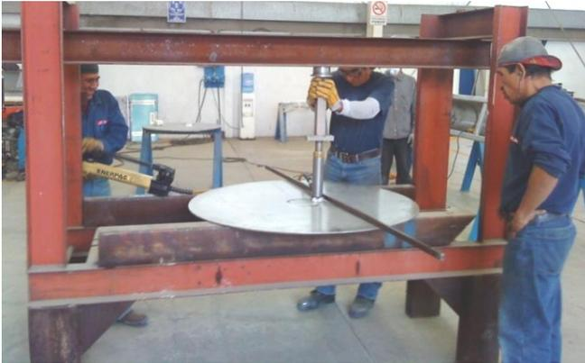
Al observar la vulnerabilidad que se tenía a la deformación por aporte de calor del acero inoxidable agregué al diseño 4 canaletas de acero inoxidable que funcionarían como refuerzos en la placa circular. El diseño de la mesa incluyó entre sus características que la mesa fuera desmontable de forma fácil, por lo que con las piezas terminadas se realizó el ensamble para verificar el funcionamiento.
