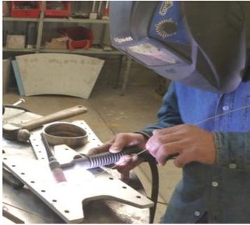
Figura 2.21 Soldadura de pieza de ensamble con proceso GTAW
