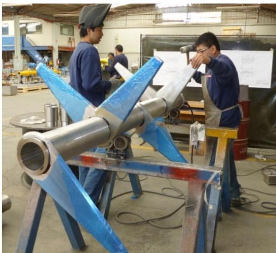
Figura 2.17- Colocación de aspas de agitación en la barra hueca.
