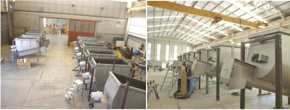
Una vez aprobado el ensamble general de todos los componentes, se procedio a dar el acabado final al cuerpo del bunker, el cual consiste en desensamblar todas las piezas y llevar el cuerpo de la máquina, guardas y parrillas de protección al área de granallado o sandblast donde se someteran a un chorro a alta presión de perlas diminutas de vidrio que les darán un característico acabado superficial de metal opaco.
