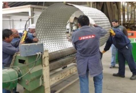
Figura 2.12- Roladora. Placas de hasta 3/8" de espesor
