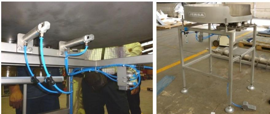
El diseño final de la mesa quedó de la siguiente forma donde se puede observar el mecanismo de trinquete accionado por un pistón neumático.
