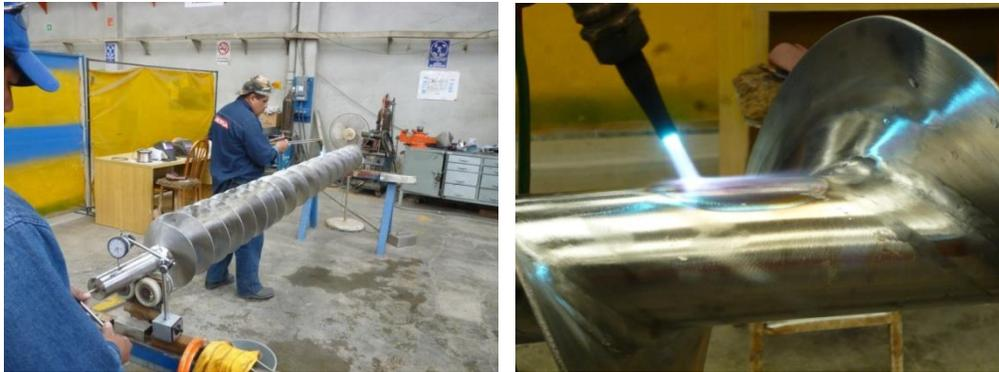
Figura 2.20 Alineación de flecha helicoidal suministrando calor con soplete de oxígeno y acetileno.
