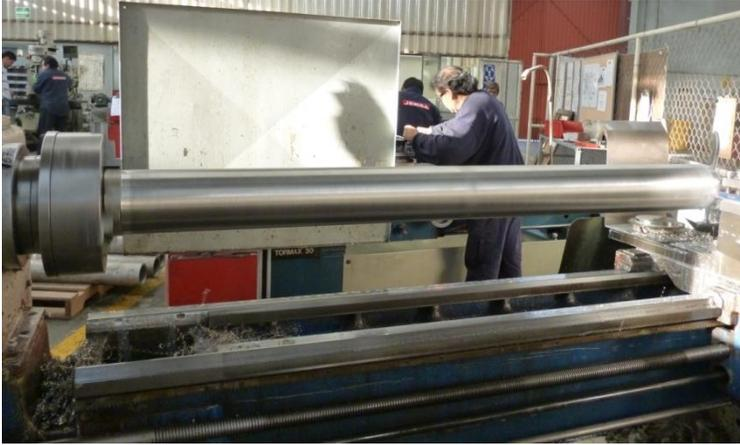
Figura 2.16- Proceso de torneado a una barra hueca de acero inoxidable.
