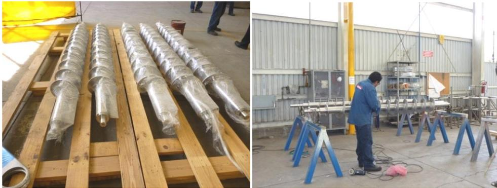
Posteriormente se introdujo cada una de las flechas agitadoras y helicoidales comprobando sus dimensiones y desplazamiento en el cuerpo del bunker demostrando su correcto funcionamiento.
