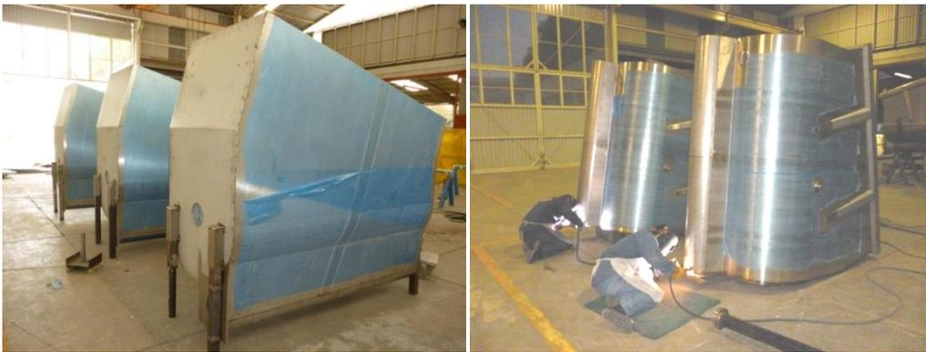
La colocación de los refuerzos laterales y canaletas fue el siguiente paso para completar los trabajos de soldadura del cuerpo de los bunkers.
