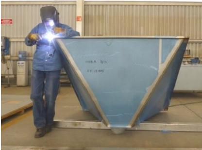
Figura 2.23- Soldadura de tolva de acero inoxidable aplicando proceso GTAW.
