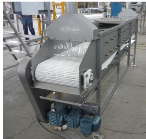
Figura 2.10.- Túnel de vapor para frascos de mermelada.
