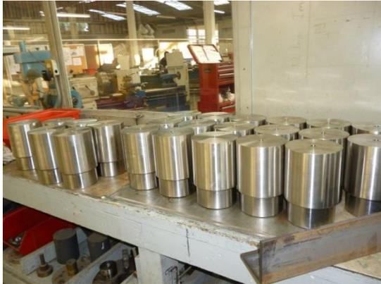
Figura 2.6.- Piezas maquinadas de acero inoxidable tipo AISI 304 Utilizadas en equipos mezcladoras de carne de JERSA.
