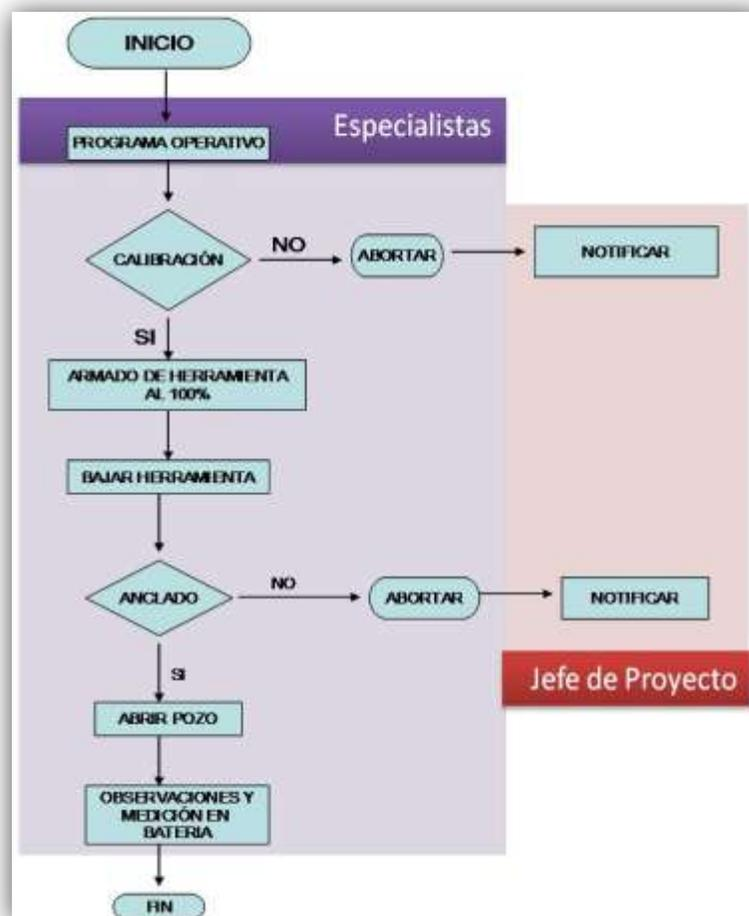
Figura 17. Diagrama de Flujo para la Instalación en Campo
