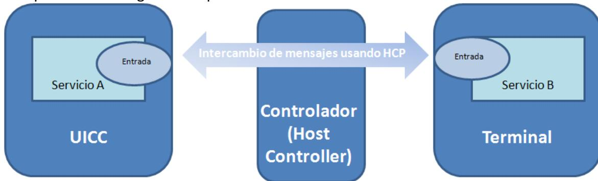
*Figura 17. Diagrama HCP, intercambio de mensajes entre la (U)SIM y el terminal.*
