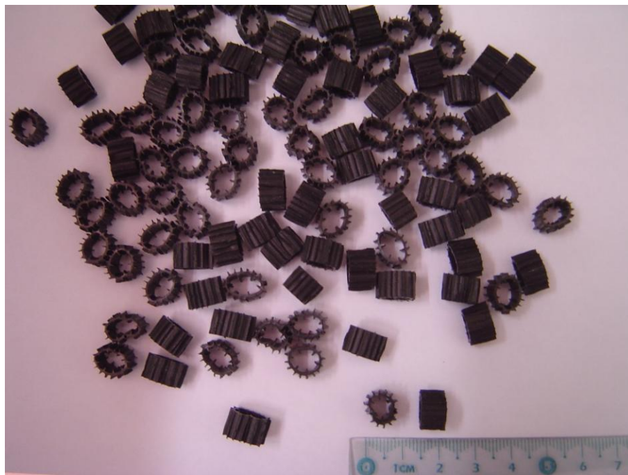
Figura 3.5 Empaques de polietileno utilizados como lecho móvil.
