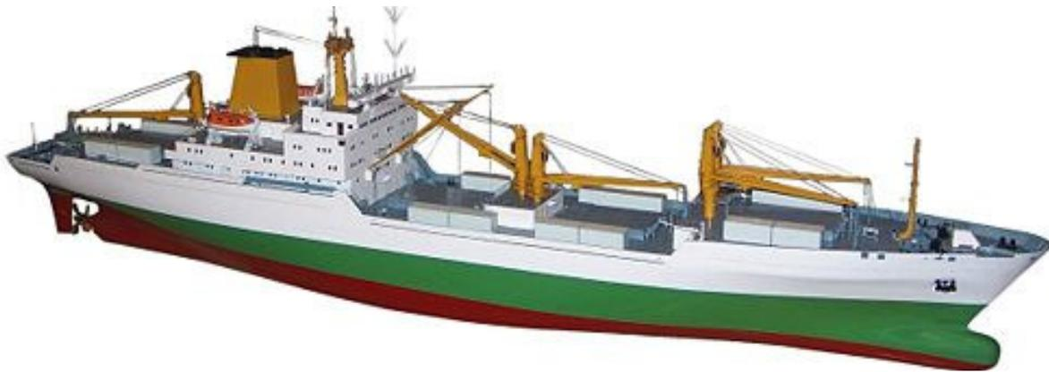
**Imagen 1.04.- Modelo de proyecto de barco para transporte de chatarra a gran escala**
