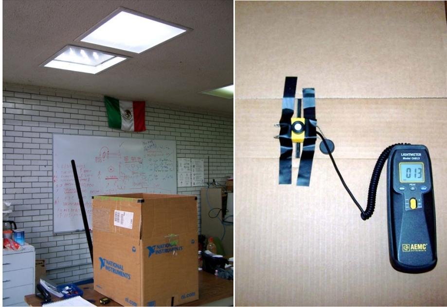
Figura 49. Medición de la intensidad lumínica.
