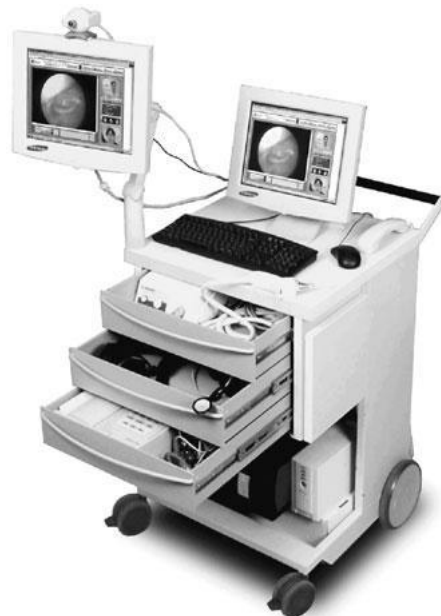
Figura 2.1. Equipo de telemedicina que cuenta con estetoscopio, electrocardiograma, dermatoscopio, otoscopio, dentaloscopio y esfigmomanómetro. Permite interacción en vivo con el paciente y el médico.
