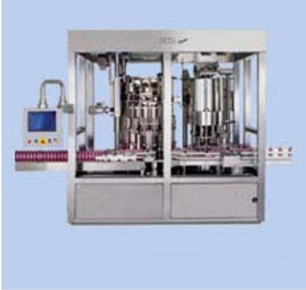
Esta máquina implementa los procesos de llenado y colocación de tapa en un sistema continuo. Su punto de operación máximo se halla en 200 botellas por minuto.
