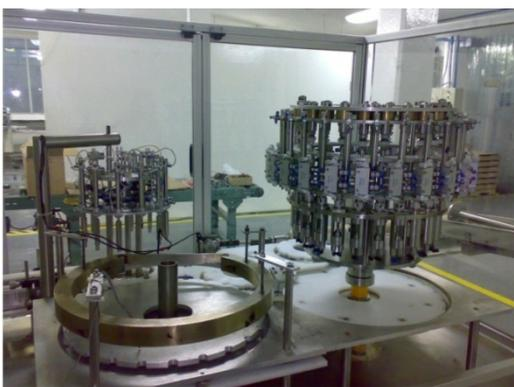
Fig. 5.40. Sistema de llenado, calentamiento y sellado
