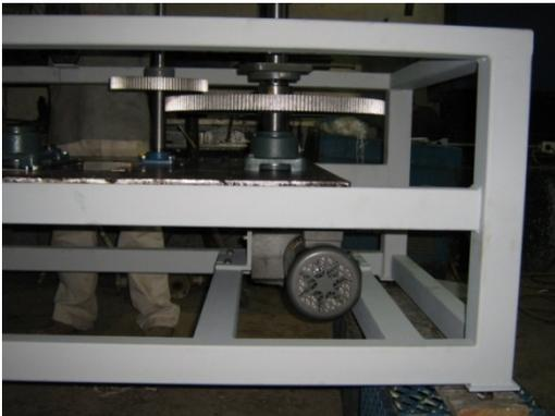
Fig. 5.64. Detalle de la transmisión principal
