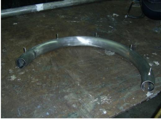
Fig. 5.42. Reflector para calentamiento
