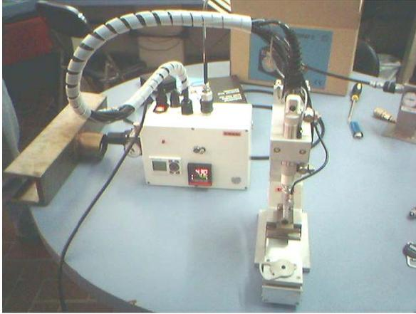
Fig. 5.24. Control de temperatura y sistema de deformación
