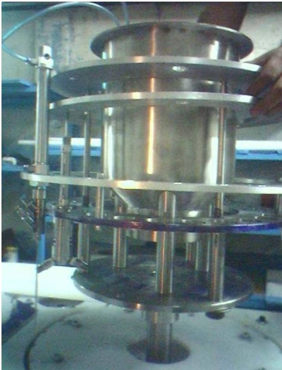
Fig. 5.44. Tanque para el sistema de llenado
