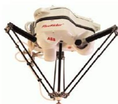
Figura 1.1b robot manipulador paralelo delta
