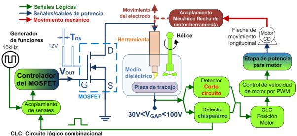
Ton: Tiempo de encendido del transistor
