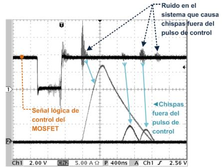
▲ Figura 5.14. Comportamiento inestable del sistema propuesto.
