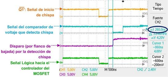
▲ Figura 5.13. Señales detectadas por chispa fuera de la señal de encendido del MOSFET.
