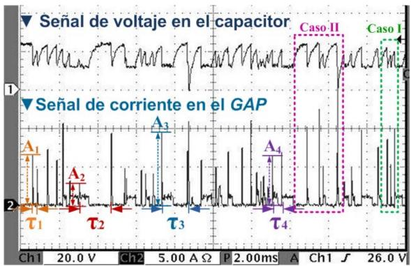
▲ Figura 3.8. Señales de voltaje (con referencia en □)y corriente (con referencia en □) obtenidas del maquinado del experimento No. 6.
