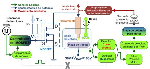
▲ Figura 5.2. Sistema propuesto sin retroalimentación. Configuración de pulsos isofrecuenciales.
