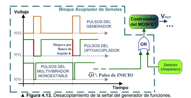
La interacción entre la señal  $\overline{Q1}$ , de la figura 4.13, y la señal proveniente del detector de chispa/arco tiene como objetivo adelantar el flanco de subida, que apaga al transistor, en función de la generación de chispa en el *GAP*. En consecuencia se generan pulsos de corriente isoenergéticos, cuya amplitud está en función de los tiempos de reacción y respuesta de los dispositivos encargados de detectar chispa/arco y apagar al MOSFET. Esto se muestra en la figura 4.14.
