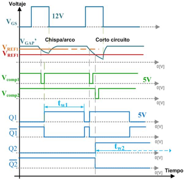
▲ Figura 4.9. Respuesta de los comparadores de voltaje NE529 y los multivibradores monoestables 74LS123 dada una condición de chispa/arco y corto circuito en el *GAP*.
