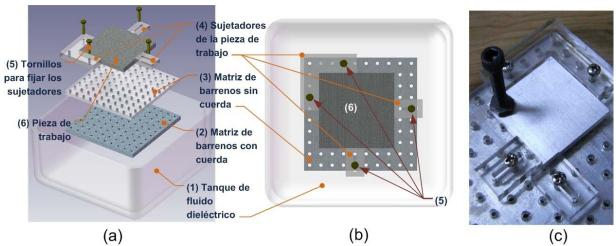
▲ Figura 3.3. Sistema de sujeción para el centro de maquinado por µEDM desarrollado en el GMM. (a)Vista explosiva. (b)Vista superior. (c)Fotografía del sistema de fijación de piezas de trabajo propuesto.
