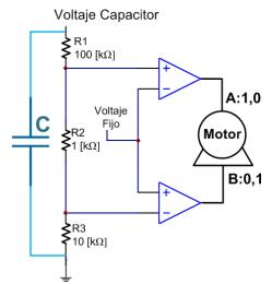
▲ Figura 3.6. Circuito monitor del estado del GAP.
