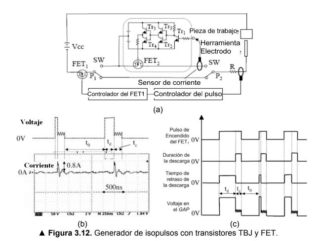
Cabe señalar que la detección de inicio de chispa se logra mediante sensores de corriente ultrarrápidos, cuyo principio de funcionamiento es el Efecto Hall, su tiempo de reacción debe ser del orden de unos cuantos nanosegundos. Comercialmente este tipo de sensores no son de fácil acceso.
