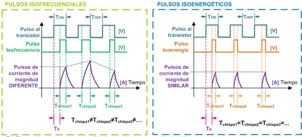
Td: Tiempo de retraso entre encendido de transistor y generación de chispa
