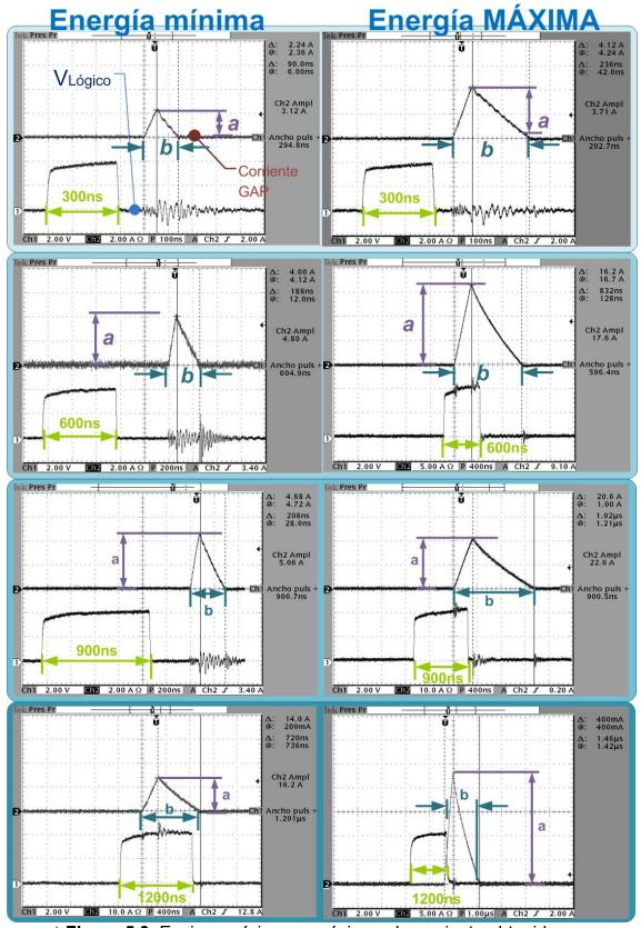
▲ Figura 5.3. Espigas mínimas y máximas de corriente obtenidas por diferentes tiempos de encendido del MOSFET. V<sub>Lógico</sub> son los pulsos lógicos de control que entran al controlador del MOSFET.
