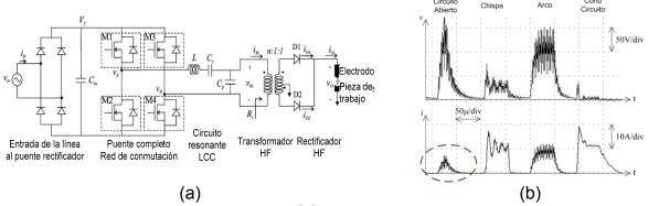
▲ Figura 3.10. Fuente resonante LCC. (a) Esquema del circuito eléctrico. (b) Pulsos EDM obtenidos experimentalmente.
