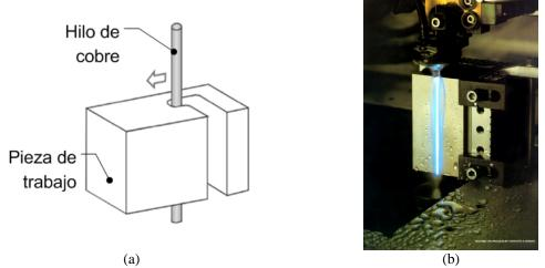
▲ Figura 1.8. Maquina WEDM. (a) Esquema funcional. (b)Fotografía del proceso en operación.
