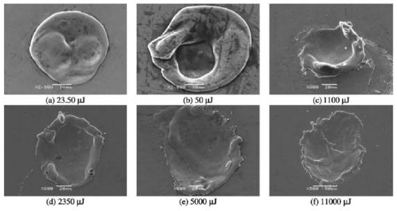
▲ Figura 1.18. Microcráteres hechos con una fuente RC a 2µm de GAP [5].
