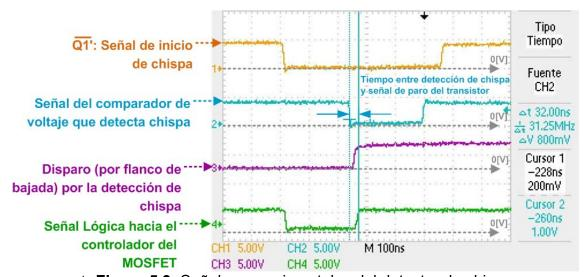
▲ Figura 5.9. Señales experimentales del detector de chispa.
