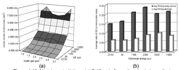
▲ Figura 1.19. Modelos estadísticos. (a) Gráfica de 3 coordenadas independientes mostrando la correlación entre energía descargada por chispa, volumen de la cavidad obtenida y distancia de *GAP*. (b) Histograma de la desviación estándar del diámetro y volumen de los cráteres generados en diversas muestras generadas a diferentes niveles de energía específica cada una [5].
