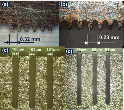
▲ Figura 3.16. Maquinados por μWEDM. Microdientes y microrendijas maquinados con alambre de cobre de (a,c) Ø70μm y (b,d) Ø50μm.
