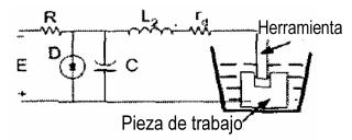
▲ Figura 1.12. Fuente EDM con semiconductores y elementos eléctricos pasivos.
