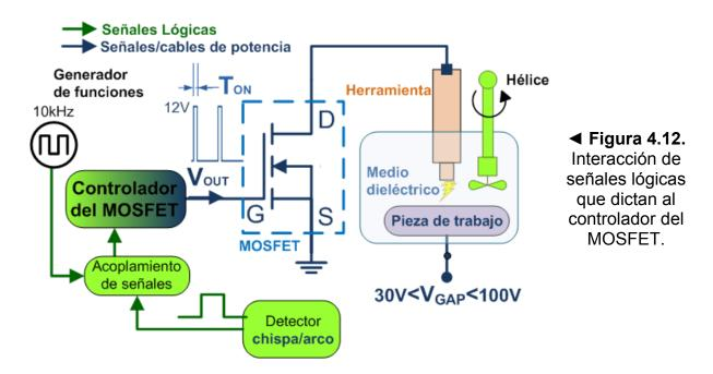
La señal de salida del generador de funciones, por seguridad, no debe interactuar directamente con el sistema de generación de pulsos de corriente para µEDM; por lo que sus señales de salida son optoacopladas mediante el dispositivo 6N137. Al
