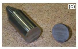
Resultados de cortes: (a) Esmeril (b) MDM (*Metal Desintegration Machining*) (c)EDM (Sistema propuesto)
