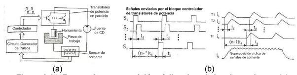
▲ Figura 3.14. Fuente de superposición cíclica de señales de corriente. (a) Diagrama a bloques de la fuente. (b) Señales de control y de corriente de salida del sistema.
