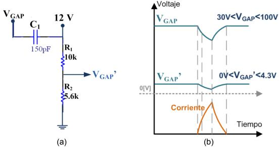
▲ Figura 4.4. Acoplamiento de CD/CD. (a) Diagrama esquemático. (b) Niveles de voltaje resultantes.
