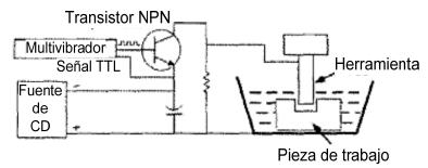
▲ Figura 1.13. Fuente EDM con transistor como interruptor.
