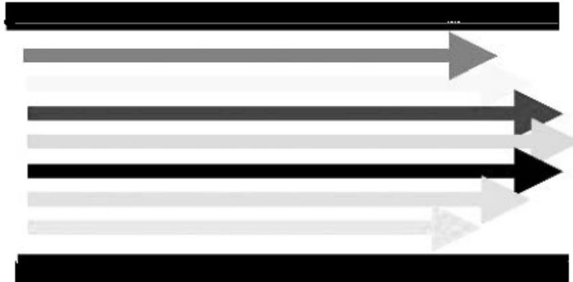
Fig. 1.5. Tinta dentro de un tubo con fluido newtoniano bajo un régimen laminar de flujo. Las líneas de flujo permanecen paralelas entre si.
