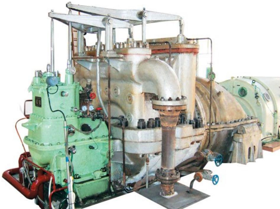
Figura 1.7: Turbina con extracción de vapor [7].
