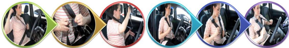
Figura 5: Proceso de instalación de Pregnancy Seat Belt Harness [15]
