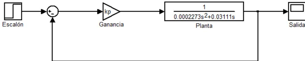
Fig. 3-1 Diagrama de bloques del controlador proporcional
